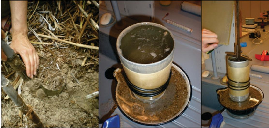
Abb. 3-12: Ausgraben des Stechzylinders (links) und Durchlässigkeitsmessung im Labor
