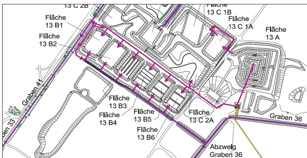
Abb. 7-2: Ausschnitt des Übersichtsplans der Versuchsanlagen: 13 B1 – Sandfilter, 13 B2 – Sandfilter mit Lehm, 13 B3 – Sandfilter mit Längsgräben, 13 B4 – Bepflanzter Teich, 13 B5 – Teich mit Pflanzenschwimmatten, 13 B6 – Unbepflanzter Teich, 13 A – Graben [AKUT 2004]
