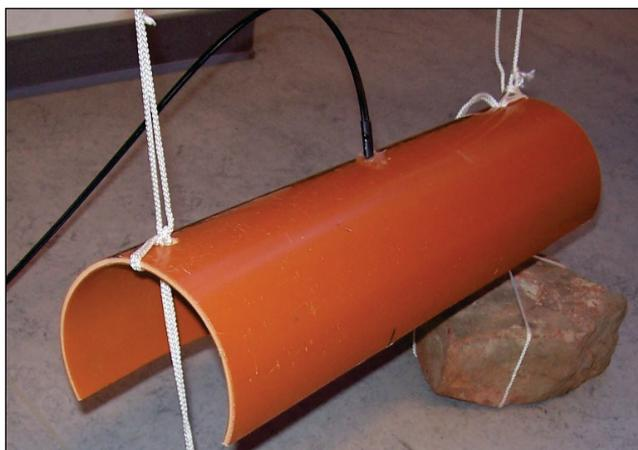
Abb. 7-1: Messvorrichtung mit Sensor des Lichtleiterfluorometers in Rohrstück und Beschwerung
