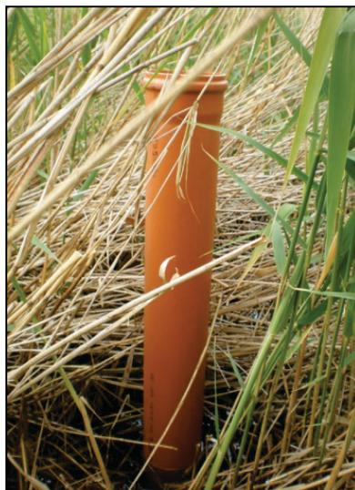
Abb. 3-13: Rohr des Open-End-Tests auf dem Sandfilter mit Lehm
