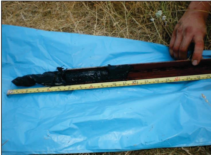
Abb. 7-4: Moorkammerbohrer mit Bodenprobe aus dem Sandfilter mit Lehm
