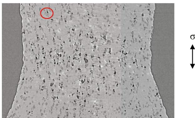
**Abb. 5.4.8** Partikelbruch aus Abb. 5.4.7c-e im Längsschnitt durch die gesamten Probe bei  $0,97t_{fr}$
