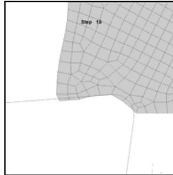
**Bild 4.23** Überschneidung im Anschnitt zwischen Werkstückelementen und der Werkzeugberandung
