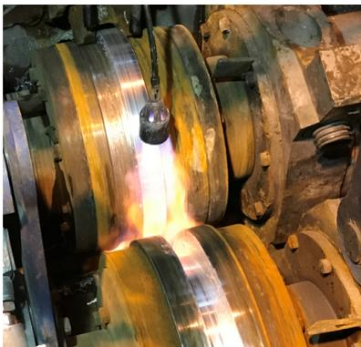
(a) Vorwärmung der Arbeitswalzen mittels Gasbrenner
