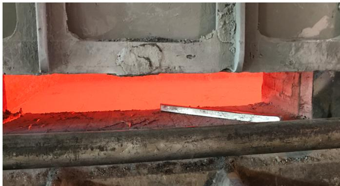
(b) Vorwärmung der Schnittstücke durch deren Positionierung an einer Schmelzofenöffnung
