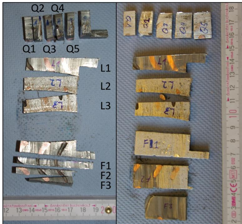
Abbildung 5.12: Darstellung der gesägten Proben zur anschließenden metallographischen Untersuchung
