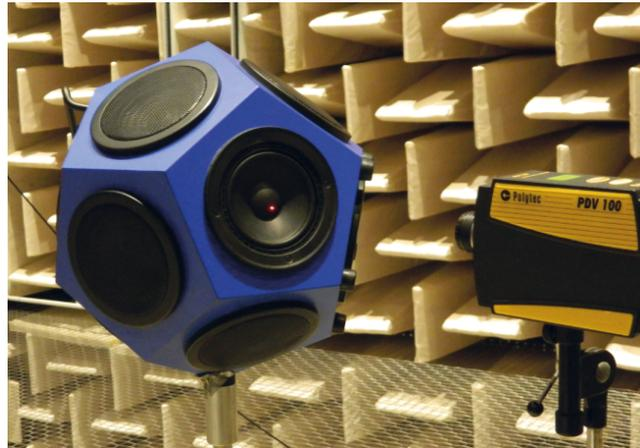
*Abbildung 5.40: Foto des Messaufbaus zur Messung der Membranschnelle des Dodekaederlautsprechers im reflexionsarmen Raum*
