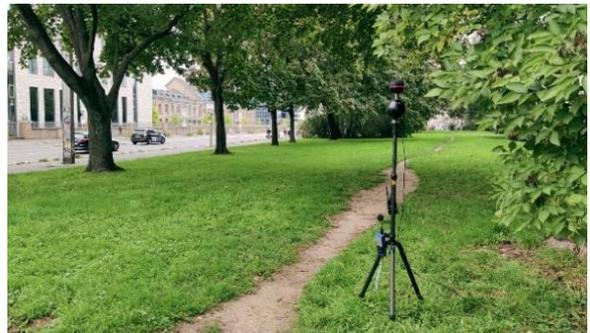
**Abbildung 1:** Aufbau zur Messung von audio-visuellen Straßenverkehrsszenen mit Ambisonics-Mikrofon, Schallpegelmessgerät und 360°-Kamera
