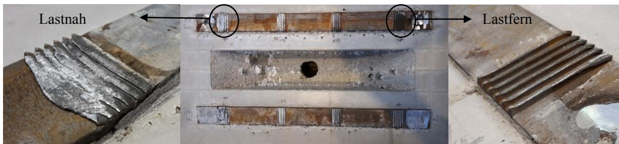
Abb. 7.5: Stark zerdrückte Zähne im Knotenelement nahe der Krafteinleitung (IV/V1) (links) und aufgebogene Zähne fern der Lasteinleitung (IV/V1) (rechts)
