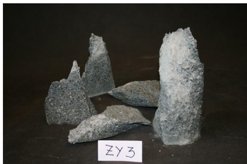
*Abb. B.2.10: Bruchbilder der Zylinder*
