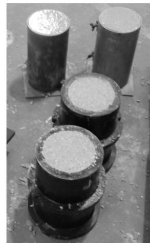
Abb. B2.2 Zylinderherstellung
