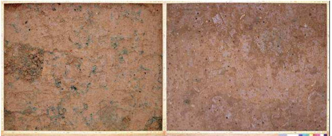
*Abbildung 7-3: Horizontalschnitte in 15 cm (links) und 70 cm (rechts) nach einmaliger Beregnung mit 30 mm Brilliant Blue/Kaliumbromid-Tracer-Lösung*
