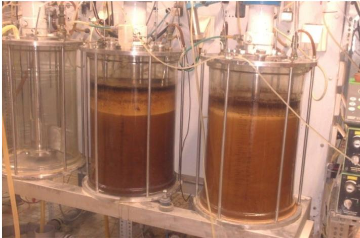
**Abbildung 4-51:** Pilotanlage der VH-Berlin mit vier Fermentern
