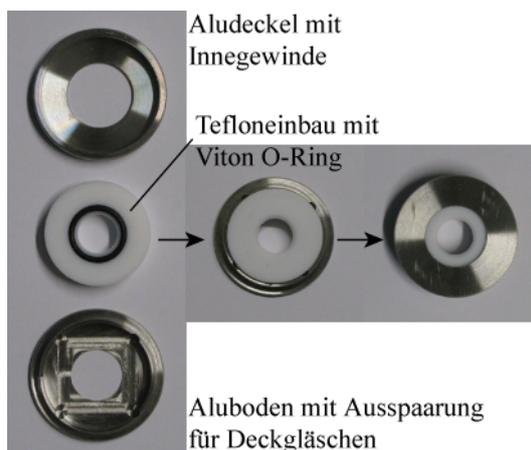
Abbildung 1.7: Deckgläschenhalter bestehend aus Edelstahlboden, Edelstahldeckel und Tefloneinbau. Das Deckgläschen wurde mit dem Tefloneinbau in die Aussparung im Boden eingepreßt. Durch den Einsatz von gereinigten und chemisch inerten Materialien können Probenoberfläche und Puffer nicht verunreinigen.
