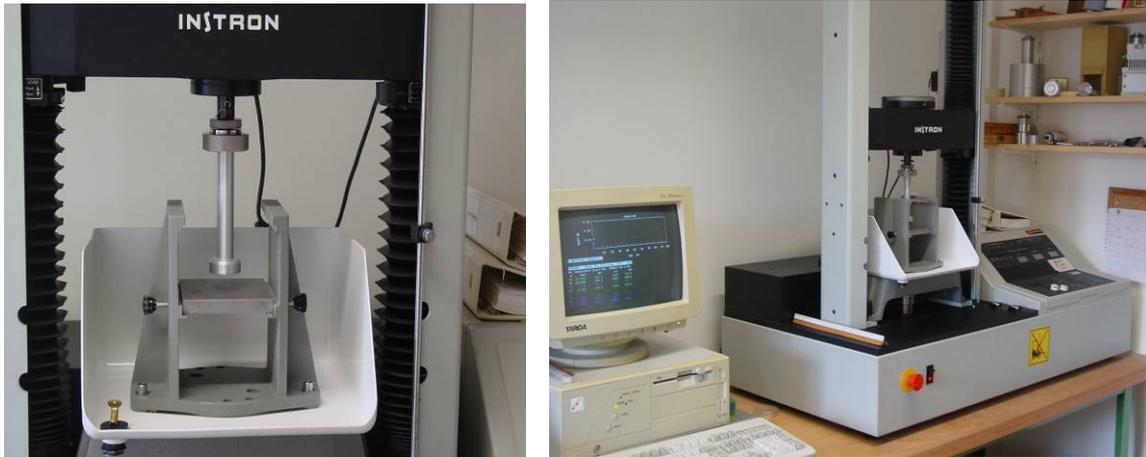
Abb. 4.1. Materialprüfmaschine Instron Modell 4301
