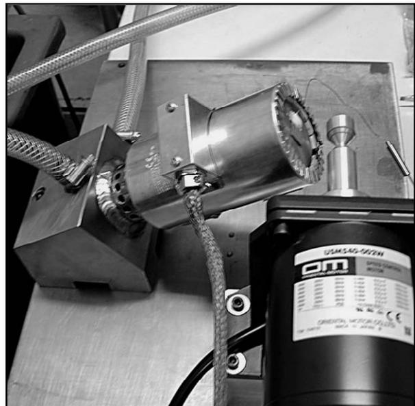
**Bild 4-4:** Kalottenschliffgerät zur Bestimmung der Schichtdicke und der Beständigkeit gegen Abrasion auch bei erhöhter Proben temperatur
