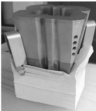
Abbildung 11: Stanzisen für das Gegendruckstanzen [58]
