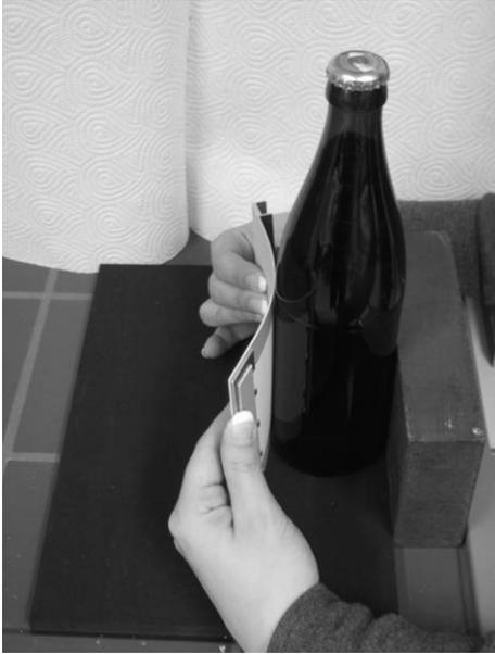
Abbildung 50: Aufsetzen der Etiketten auf die Flaschen
