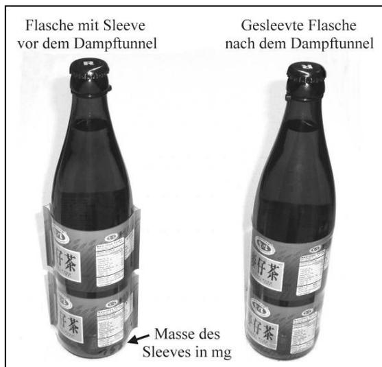
Abbildung 39: Sleeven der Flaschen zur Bestimmung der Klebstoffmenge
