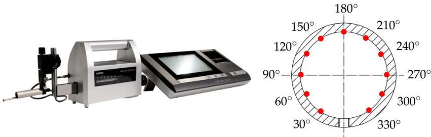
Abbildung 5.3: Rauheitsmessgerät SURFCOM TOUCH Series der Firma Zeiss und Darstellung der Messpositionen über dem Lagerumfang [15].
