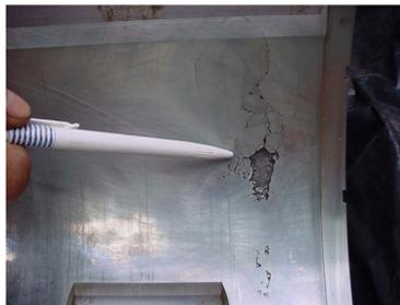
Abbildung 2.21: Ermüdungsrisse und Werkstofffreilegung durch dynamische Überlast [34].<sup>4</sup>
