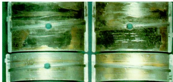
Abbildung 2.19: Fressen mit vollständiger Ablösung der Zwischenschicht sowie Ausschmelzung, Metallverschleiß und schwerwiegender Riefenbildung [34].<sup>2</sup>
