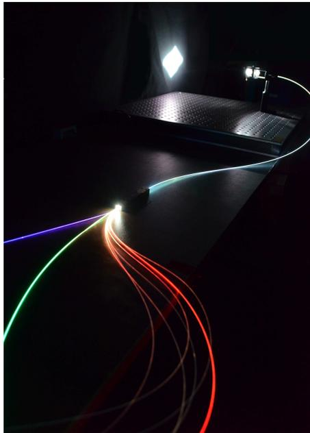
**Abbildung 6.17:** Fotografische Aufnahme der RLL samt des Beleuchtungspfades ohne die Feldlinse. Die Ausleuchtung der einzelnen Spektralfarben resultiert in einem homogenen Rechteck, welches entsprechend der Gewichtung von RGB im Zentrum einen mittleren resultierenden Farbort im Unbuntpunkt aufweist.
