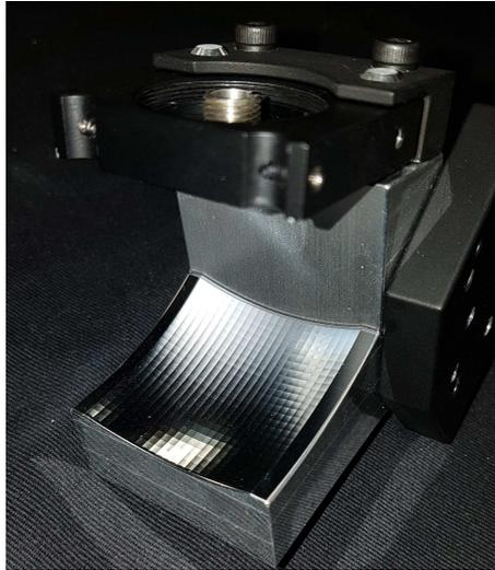
**Abbildung 6.21:** Fotografische Aufnahme des für die Charakterisierung genutzten FFR, hergestellt in einem Drehprozess aus einem Aluminiumblock.
