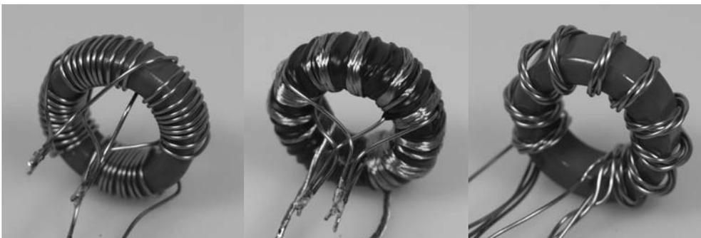
Abbildung 5.9: Untersuchte Wicklungsaufbauten
