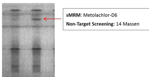
**Abbildung 3.6** Vergleich zweier Elbewasser-Extrakte: links: ohne Internen Standard; rechts: mit Internem Standard
