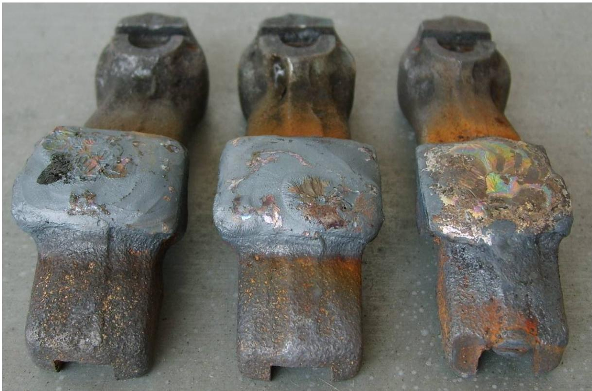
**Abbildung 19: Nach dem Lichtbogenhand-Auftragschweißen WIG- umgeschmolzene Schicht auf dem Schwinghebel- 42Cr4**
