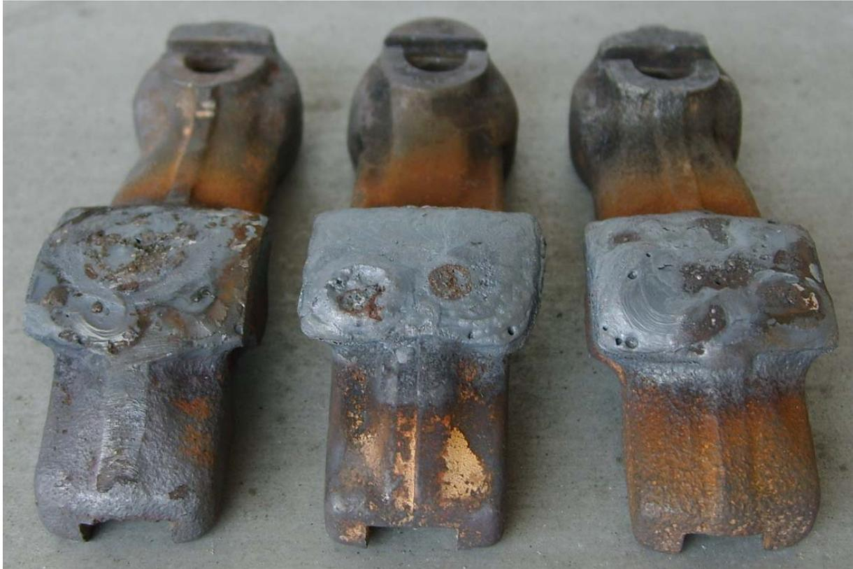
**Abbildung 18: Legierte und umgeschmolzene Schicht auf dem Schwinghebel- 42Cr4**
