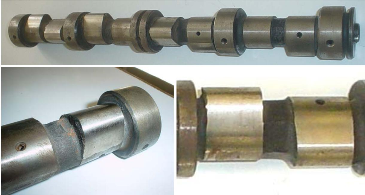
**Abbildung 21: Durch Lichtbogenhand-Auftragschweißen wiederhergestellte Nockenwelle**
