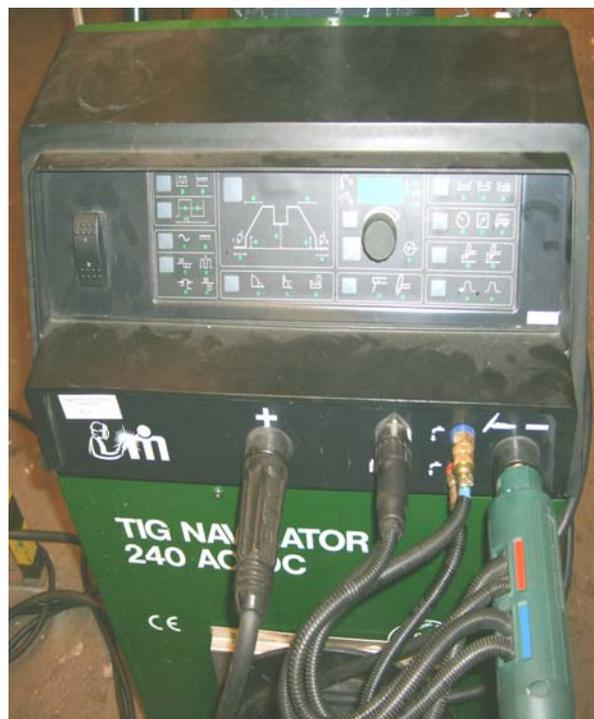
**Abbildung 13: Schweißenergiequelle TIG 240 AC/DC**
