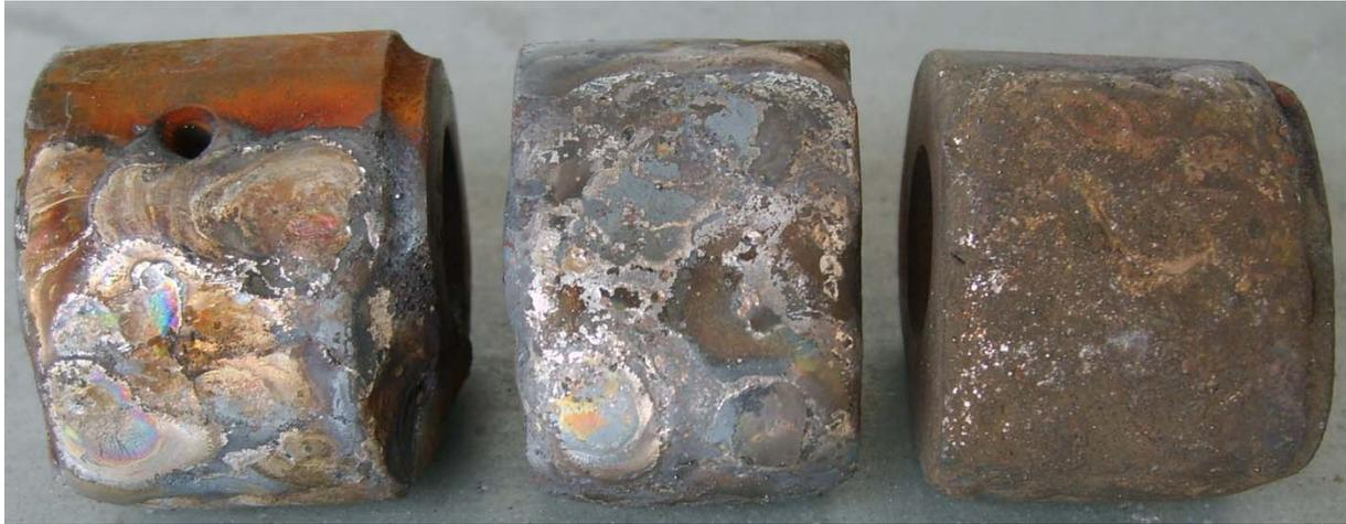
**Abbildung 20: Nach dem Lichtbogenhand-Auftragschweißen WIG- umgeschmolzene Schicht auf den Nocken- EN-GJV-400**
