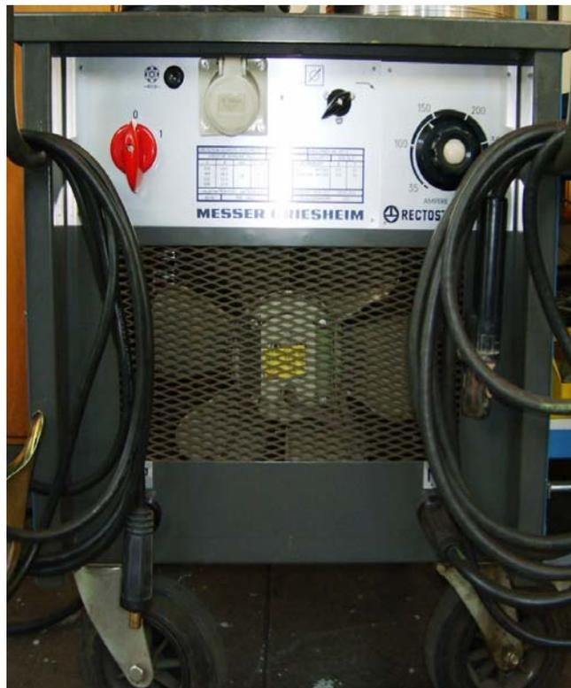
**Abbildung 12: Schweißgleichrichter von Messer Griesheim zum Lichtbogen-Hand-Auftragschweißen**
