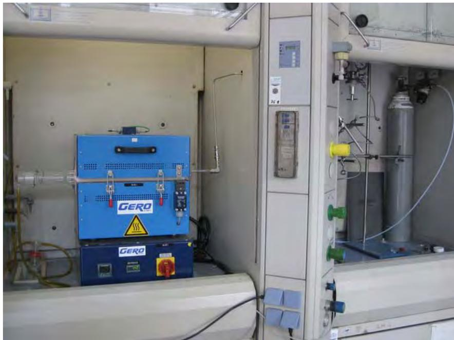
Abbildung 2: Ammonolyseanlage im Digestorium.
