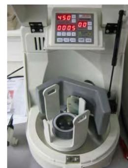
Abbildung 34: Planetenmühle, Fa. Fritsch, Typ Pulverisette.
