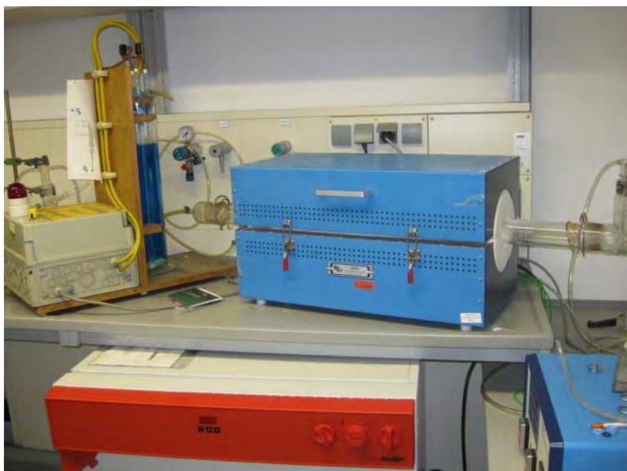
Abbildung 3: Aufbau der Oxidationsanlage. Links: Ozonisator, rechts: Rohrofen.
