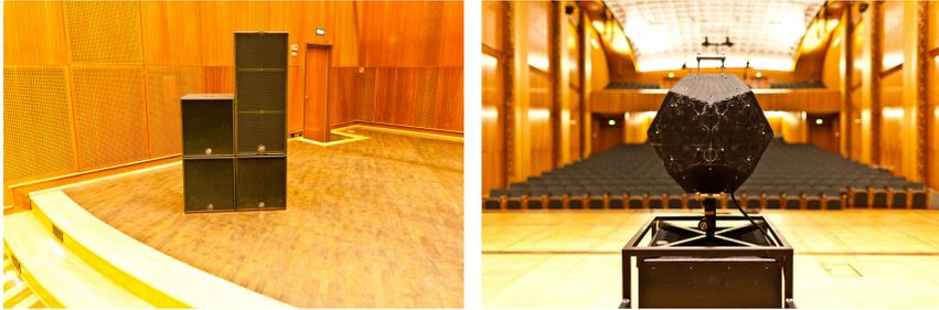
**Abbildung 3.3:** Verwendete Schallquellen mit unterschiedlicher Richtcharakteristik zur Messung von Raumimpulsantworten, gerichtet (links) und omnidirektional (rechts).
