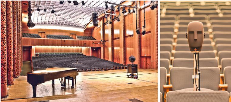
**Abbildung 2.9:** BRIR-Messung für verschiedenen Orientierungen im KVB-Saal mit *Neumann KU100* Kunstkopf aus Stade et al. (2012).
