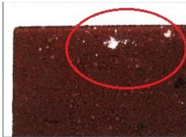
**Abb. 20:** TiO<sub>2</sub> modifizierter Pflasterstein [8]
