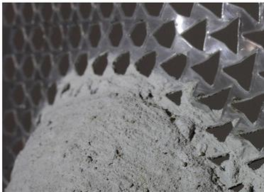
Modell der gedehnten auxetischen Struktur. Komposit: Arcyl und Beton
