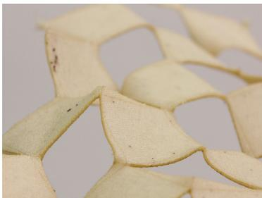
Räumlich verformte Struktur. Stoff, mit Exoidharz imprägniert.
