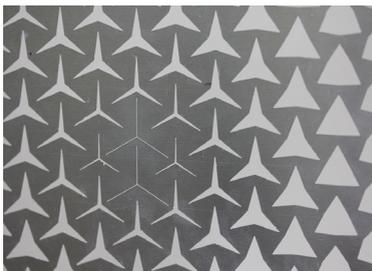
Aus Aluminium-Blech gelaserte irreguläre auxetische Struktur — unverformt
