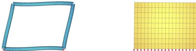
Abb.2.1 – Verformungsbilder eines Rahmens und einer Wandscheibe unter gleicher Horizontallast (gleicher Maßstab)
