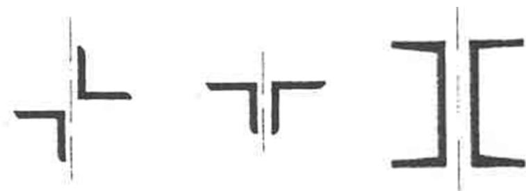
Abb.5.41 – Übliche Querschnittsformen bei Verbandsstäben
