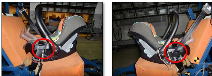
Abbildung 85: Prototyp einer Babyschale, der das Lösen vom Fahrzeugsitz bei falscher Gurtführung verhindern soll (Fahrzeuggurte sind fest mit dem Kindersitz verbunden).
