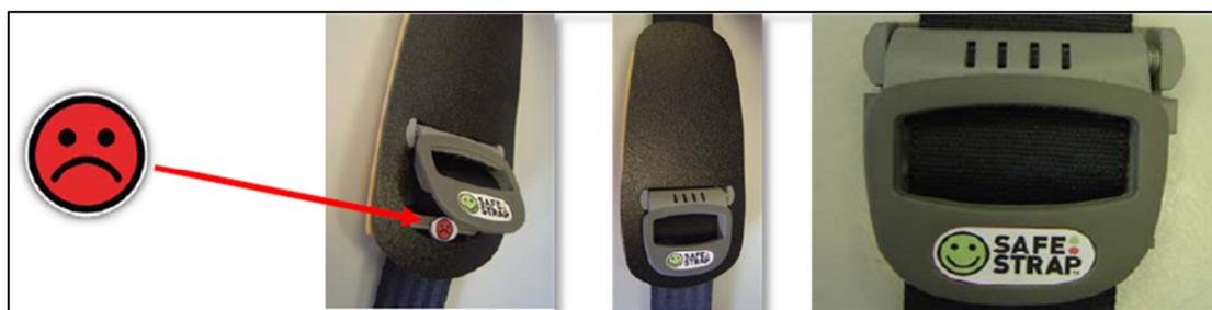
Abbildung 14: Anzeige zur Gurtkraft Links: Gurtspannkraft ist ungenügend, ein rotes Smiley ist zu sehen. Mitte, rechts: Gurtspannkraft ist ausreichend, dem Nutzer wird ein grünes Smiley angezeigt. [Bendjellal, 2006]
