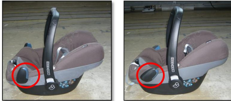
Abbildung 84: Veränderte Gurtführung bei einer Babyschale; Links: Gurtführungspunkte sind verdreht, der Schultergurt kann nicht befestigt werden; Rechts: Ursprüngliche Lösung, sowohl Becken- als auch Schultergurt können über die Sitzschale geführt werden [Holtz, 2011]
