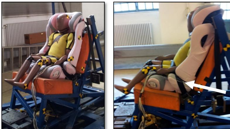
Abbildung 79: Schlittentest mit einem Gruppe 2/3 Sitz; Links: richtige Sicherung; Rechts: Einbau mit falscher Gurtführung (Pfeil)
