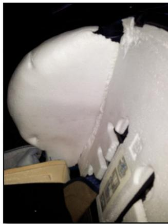
Abbildung 76: Gebrochener Kopfschutz nach einem Kopfkontakt bei einer Seitenkollision
