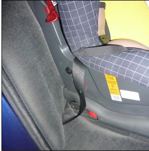
Abbildung 44: Maximale Lose im Fahrzeuggurt
