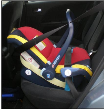
Abbildung 83: Babyschale mit Markierung des Gurtverlaufs [Holtz, 2011]
