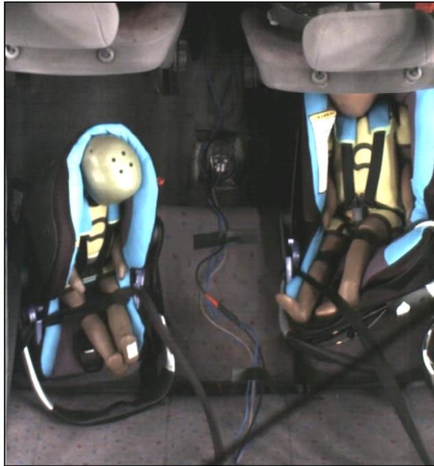
Abbildung 56: Vergleich zwischen korrekt gesicherter Babyschale (links) und Einbau mit falscher Gurtführung (rechts); Blick von oben ins Fahrzeug
