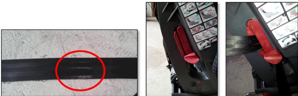
Abbildung 77: Abriebspuren am Fahrzeuggurt (links), verursacht durch die Gurtklemme im Kindersitz (mitte und rechts)
