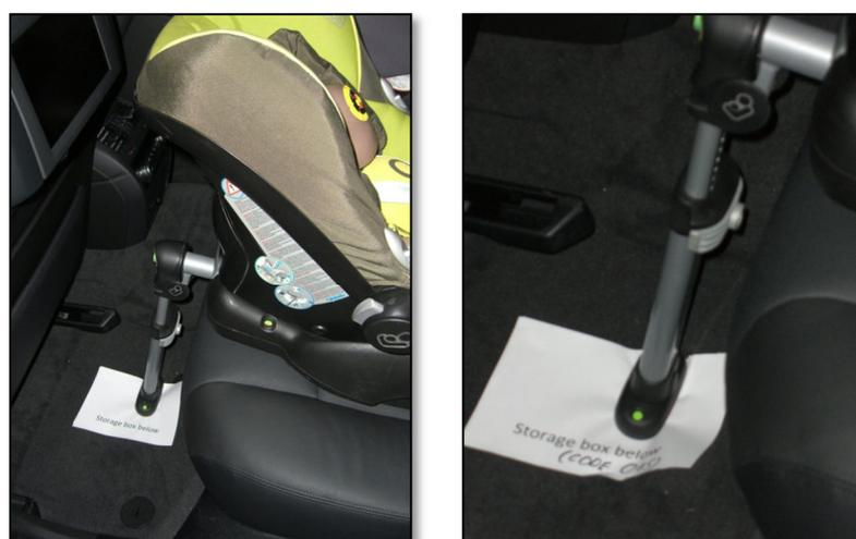
Abbildung 47: Simuliertes Staufach im Fahrzeugboden
