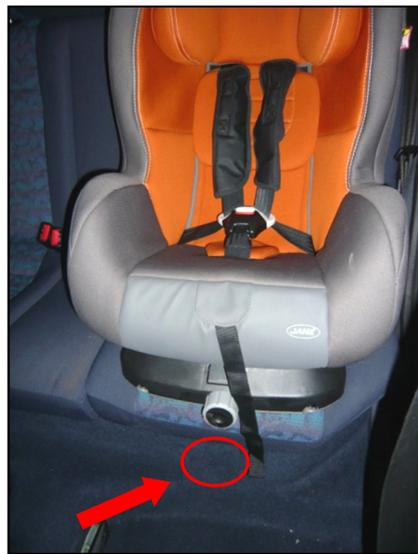
Abbildung 82: Vorgeschlagener dritter Anbindungspunkt liegt unterhalb der Fahrzeugsitzfläche
