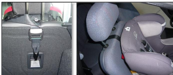
Abbildung 12: Gruppe 1 Sitz mit Top Tether Links: Gurt ist an vorgesehenem Punkt eingehängt. Ein Indikator zeigt an, dass der Gurt ausreichend gespannt ist. Rechts: Top Tether wird von der Rückseite des Kindersitzes über die Rückenlehne geführt
