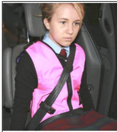
Abbildung 91: Weste zur Optimierung der Gurtführung [bestvest.co.uk]
