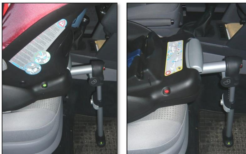
Abbildung 15: Anzeige zur richtigen Sicherung einer Babyschale Links: Die Babyschale ist richtig auf der Sitzbasis eingerastet, der Indikator zeigt einen grünen Punkt. Rechts: Die Sitzschale ist nicht richtig eingerastet, der Indikator ist rot.
