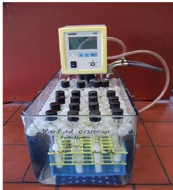
Abbildung 4.1. Wasserbad für Phasenuntersuchungen [Quelle Y. Kasaka]
