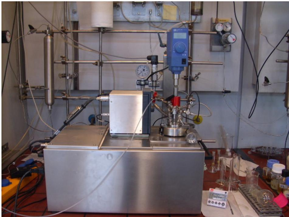
Abbildung 3.2. Hydroformylierungsreaktor mit temperierbarem Ölbad (Kryostat mit Öl Baysilon 20 oder Thermal H20S der Firma Julabo, Germany)
