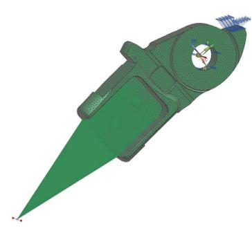
Abb. A.58: Einspannbedingung 17LK3=L20 ML-distal
