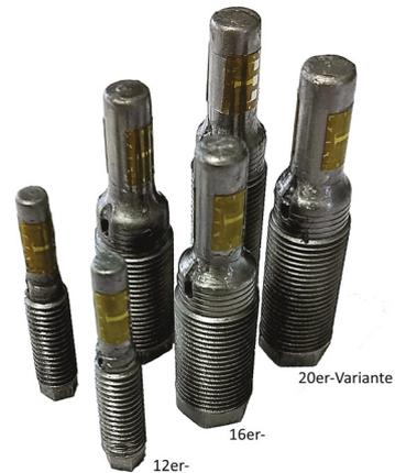
Abb. 3.19: Instrumentierte Knöchelsensoren
