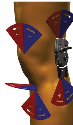
Abb. 3.40: Richtungskonvention - Orthesengelenkmomente
