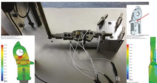
Abb. A.59: Messanordnung - FEA-Validierung Frontalmomente Knie ML-distal/-proximal
