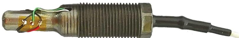
Abb. 3.20: Knöchelsensor - exemplarisch Gelenkvariante 16 mm
