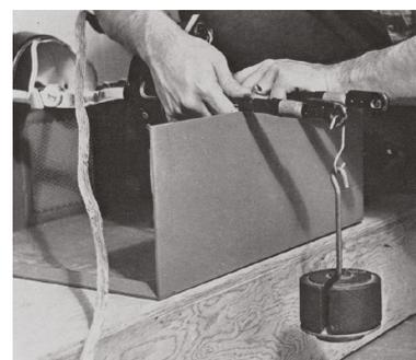
Abb. 2.18: Kalibrierung instrumentierter Adapter einer Orthese (1969) aus [54]
