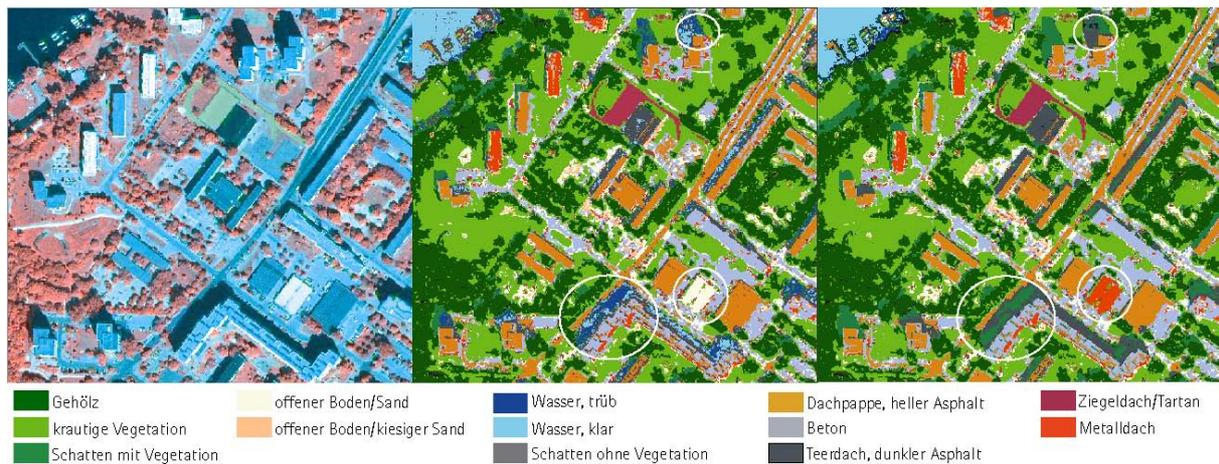
Abb. 5.30: Beispiel für die Klassifikation versiegelter Bereiche (links: Quickbird Satellitenbild, pansharpened, RGB=4,3,2, mitte: Ergebnis der MaxLike Klassifikation mit weiß eingekreisten Problemzonen, rechts: Ergebnis der wissensbasierten Nachbearbeitung)
