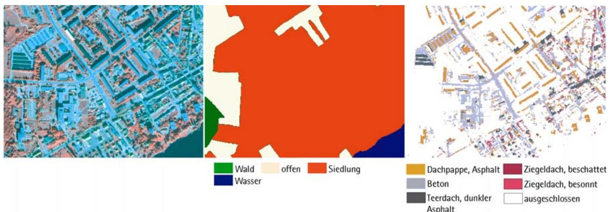
Abb. 5.22: Beispiel für die automatische Extraktion von Trainingsgebieten für die versiegelten Flächen (links: Quickbird Satellitenbild, pansharpned, RGB=4,3,2, mitte: BTNTK von 1992/93, rechts: extrahierte Trainingsgebiete)
