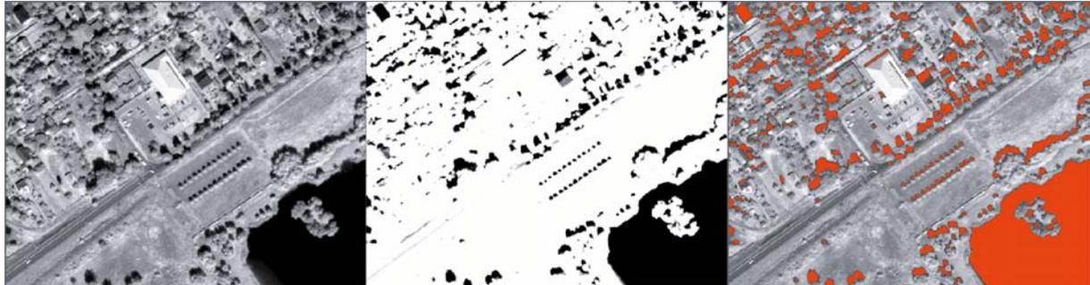
Abb. 5.18: Erzeugung einer Maske mit lokalen Minima (links: panchromatisches Satellitenbild, mitte: L5L5-gefiltertes Bild, rechts: extrahierte lokale Minima in rot, überlagert auf das panchromatische Bild)
