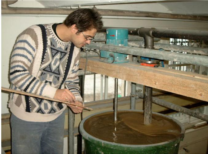
*Bild 67: Anmischen der Zementsuspension, Blick auf den Anmischbehälter während des Konditionierens*
