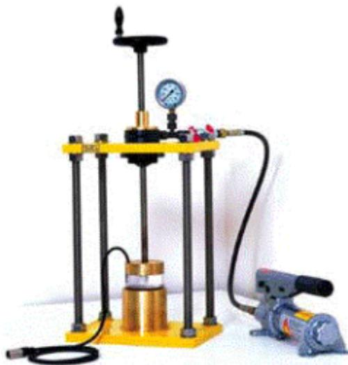
*Bild 25: Stativrahmen, eingespannter Probekörper mit HLQ-Sonde sowie Handpresse zum Andrücken der Sonde (HONARMAND 2002)*
