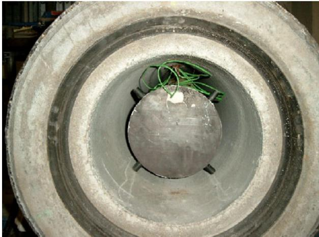
Bild 66: Blick in den Ringraum eines für die Zementation vorbereiteten Rohres
