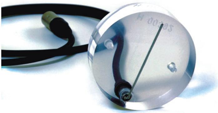
Bild 24: HLQ-Sonde für die Messung der Wärmeleitfähigkeit (HONARMAND 2002)
