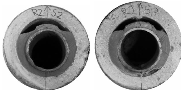
*Bild 77: Schnitte durch das Rohr mit der Zementrezeptur mit Grafit als Zuschlagstoff*
