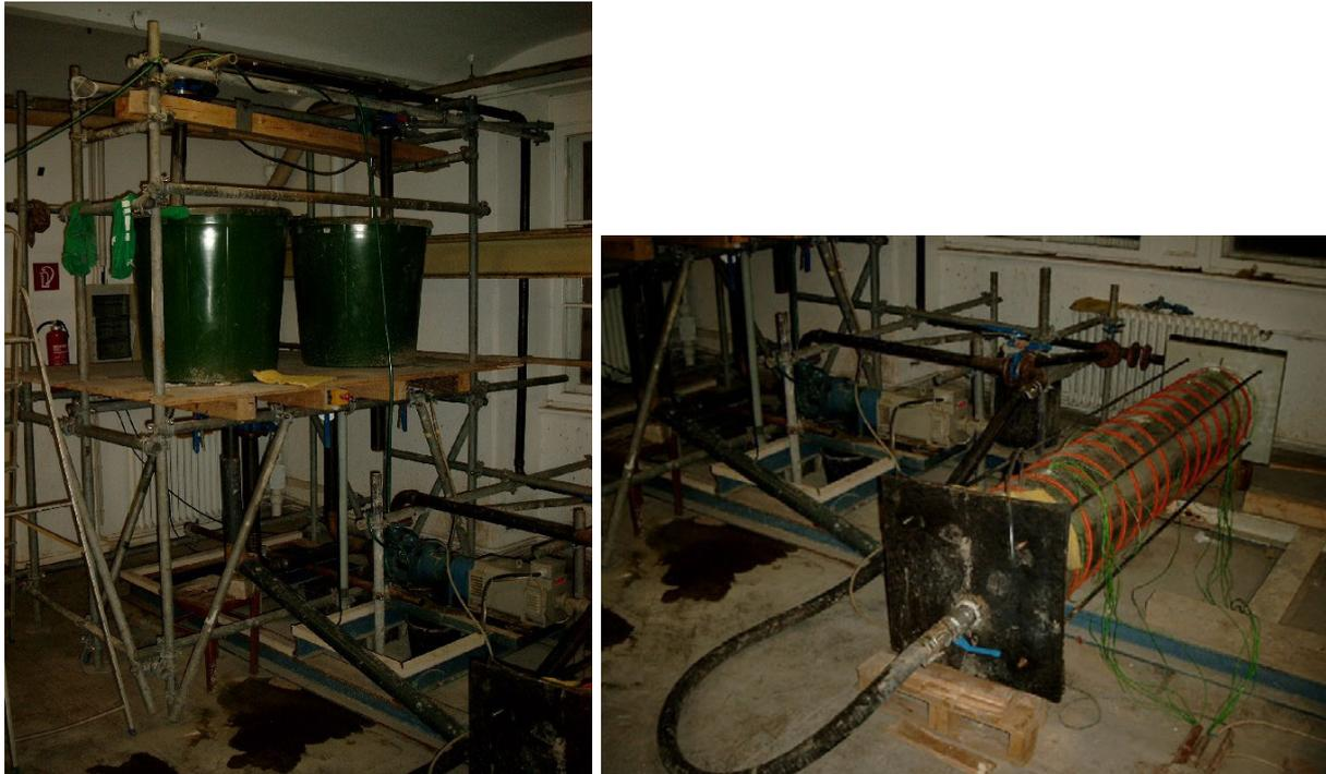
*Bild 65: Ringraum-Zementationsanlage, links Blick auf die Anmischbehälter, rechts für die Zementation vorbereitetes Rohr vor dem Umwickeln der Isolation*
