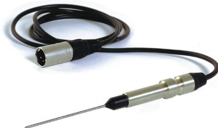
*Bild 26: VLQ-Sonde für die Messung der Wärmeleitfähigkeit (HONARMAND 2002)*
