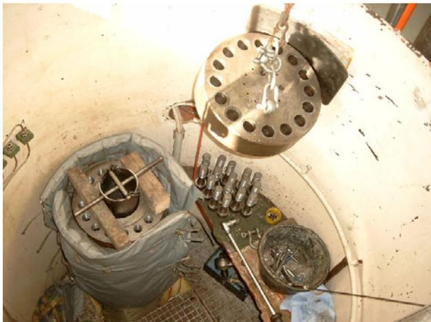
Bild 88: Draufsicht auf den Autoklaven während des Einbaus der Probekörper
