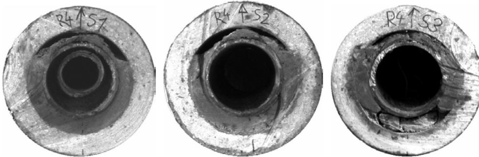
Bild 83: Schnitte durch das Rohr mit der Zementrezeptur mit Siliziumcarbid und Glasfasern
