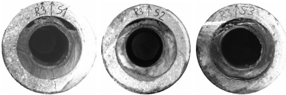
Bild 80: Schnitte durch das Rohr mit der Zementrezeptur mit Grafit und Glasfasern
