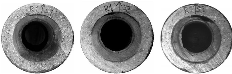
Bild 72: Schnitte durch den mit der Basis-Zementsuspension zementierten Ringraum
