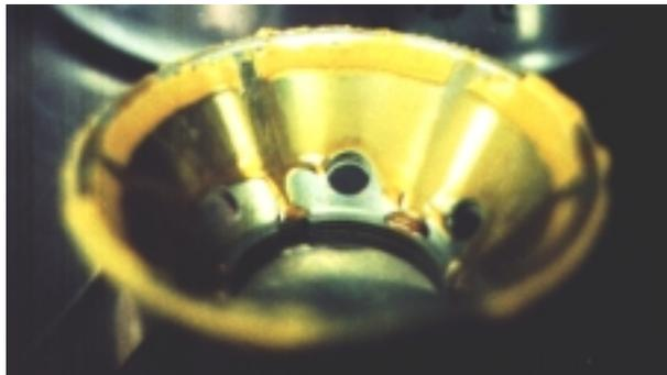
Bild 6-32: Zentrifugen-Teller TA01 nach Abtrennung der freien Ölphase.
