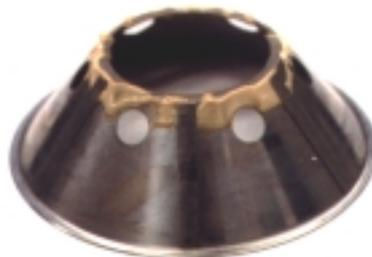
Bild 6-27: Zentrifugen-Teller TA01 nach Abtrennung der konzentrierten Ölphase als (O/W)-Emulsion pH 6,4, 50 °C
