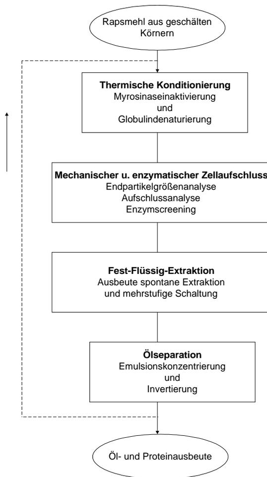
Bild 4-3: Untersuchungsablauf zum Erreichen der optimalen Öl- und Proteinausbeute durch simultane Öl- und Proteinextraktion am Beispiel Raps.
