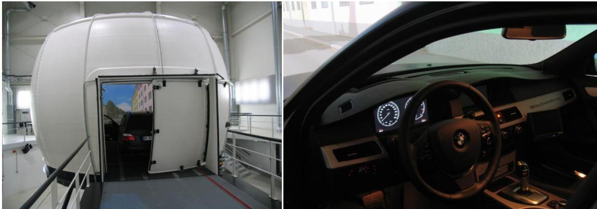
*Bild 5-2: Versuchsaufbau des dynamischer Fahrsimulators*
