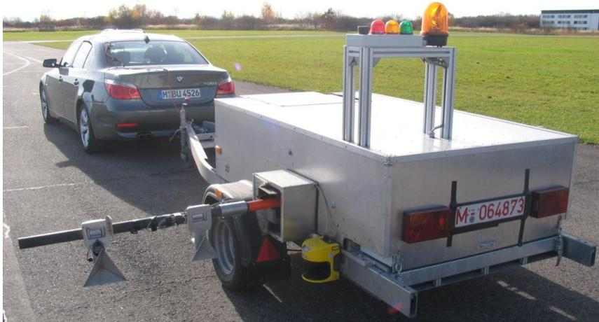
*Bild 5-13: Anhänger mit ausfahrbarem Arm als Zielobjekt*
