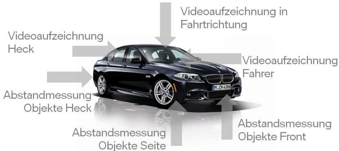
*Bild 4-1: Aufbau und Sensorik der BMW Fahrzeuge des euroFOT-Projektes [105]*
