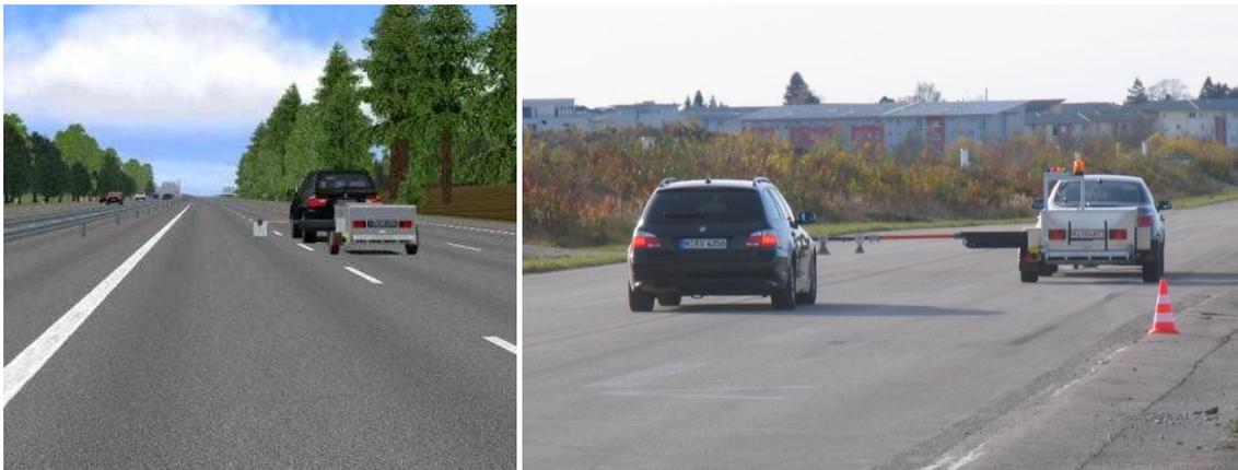
*Bild 5-14: Messsituation im Fahrsimulator (links) und im Realversuch (rechts)*
