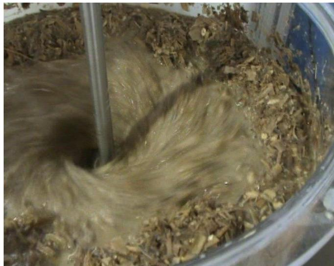
Abbildung 39: Oberflächenverhalten von Silage mit  $TS = 8 \%$ ; RUAX-Rührer®;  $d/D = 0,50$ ; drei Stufen  $z/d = 0,75$ ;  $N = 300 \text{ RPM}$
