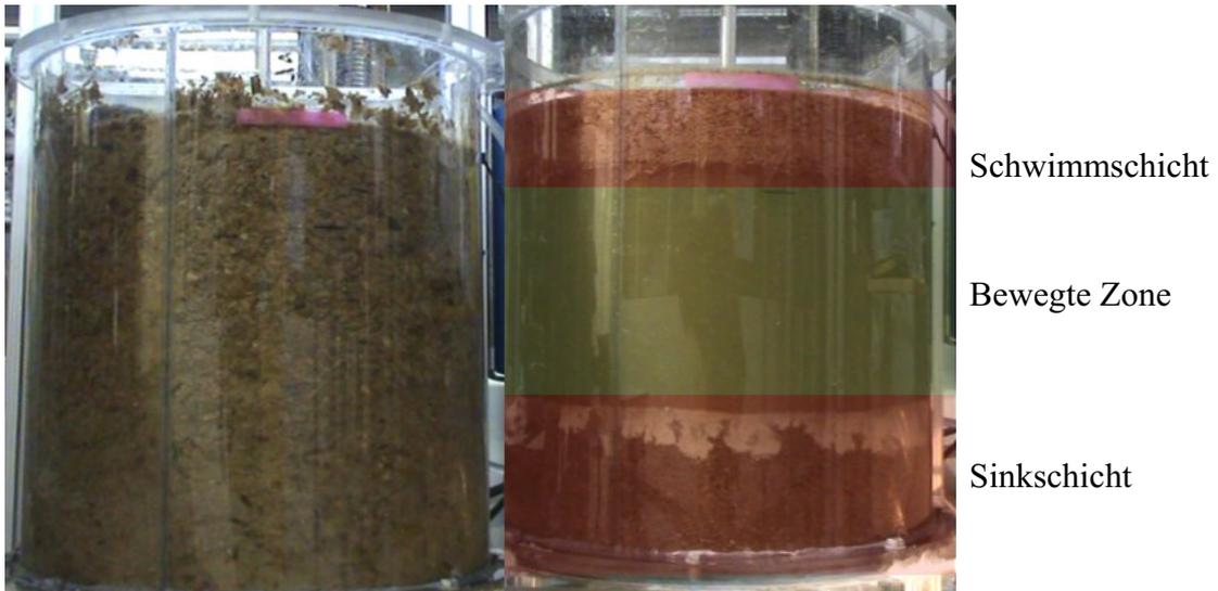
Abbildung 24: Seitenansicht des Laborbehälters; TS = 10 % mit RUAX-Rührer<sup>®</sup>; drei Stufen; N = 100 RPM; links gefüllt mit Silage; rechts gefüllt mit gemahlener Silage und einer Ausbildung von drei Zonen
