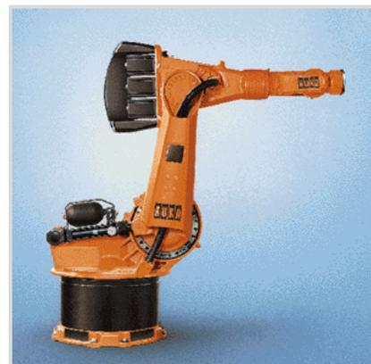
b) Knickarmroboter der Firma KUKA Roboter GmbH [Kuk-08]
