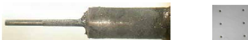
Abb. 2-2 Bohrstempel aus PKD Ø 0,2 mm und Bohrungen in Al<sub>2</sub>O<sub>3</sub> [Gill00]
