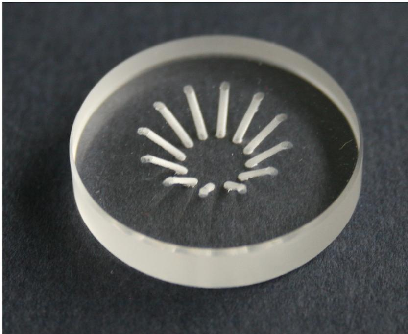
**Abb. 12-7** 0,6 mm - Schrägbohrungen in 6 mm - Quarzglas
