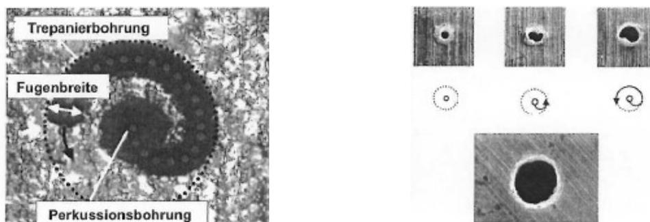
Abb. 2-10 Verfahren und Herstellung von Trepanierbohrungen [Popr05]
