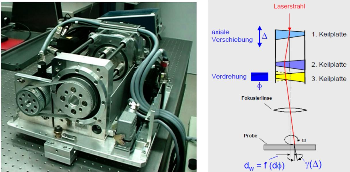
Abb. 2-16 Automatisch verstellbares Trepaniersystem, links: mechanischer Aufbau, rechts: optische Funktionsweise [Müll03]
