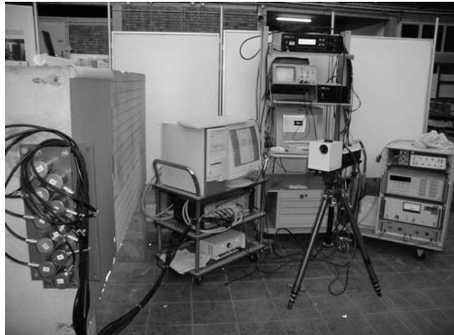
**Abb. 59:** Messapparatur mit Laservibrometer zur Visualisierung der Wellenausbreitung.
