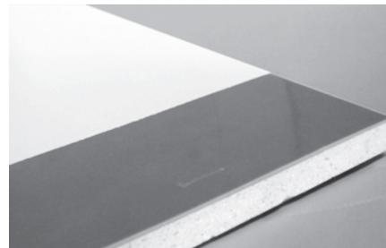
Abb 7 Schnitt durch eine up-cycling Polyurethan-Platte mit aufgesprühter PUR-Beschichtung mit UV-beständigem Deckanstrich.
