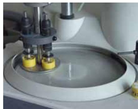
**Abb.155: Polieren der Proben**
