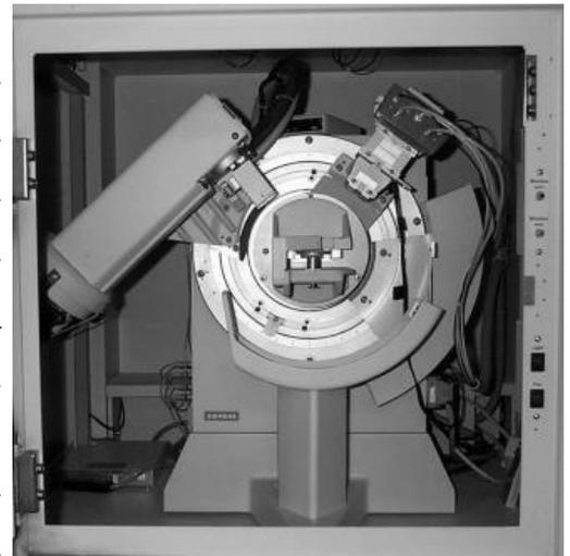
**Abb.23: Röntgenpulverdiffraktometer SIEMENS D 5000**
