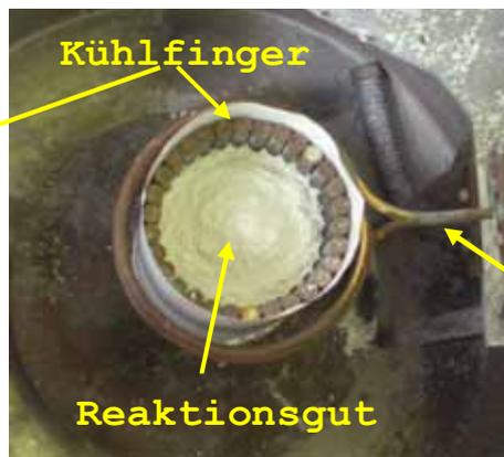
**Abb.31: Tiegel & HF-Spule**
