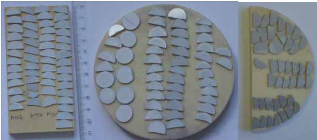
**Abb.153: Dispersionskeramiken v.l.n.r. Mullit, Spinell, C795, C786**
