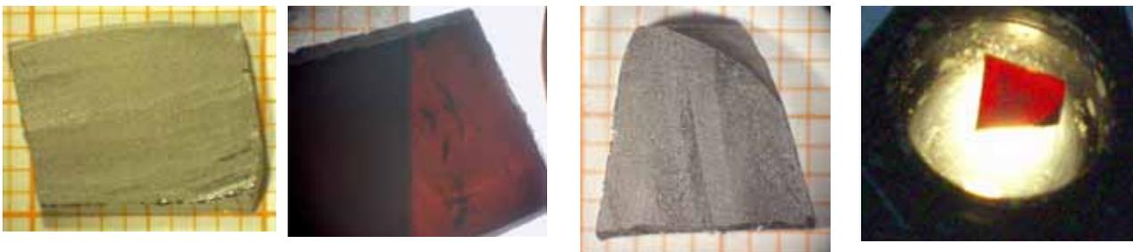
**Abb.108: Sc-Zr-O-N (6 h) / Durchlicht**
