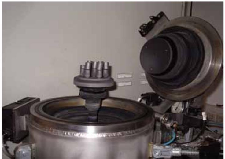
**Abb.45: Probenhalter mit Graphittiegel**
