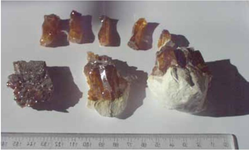
**Abb.36: ZrO<sub>2</sub>-Einkristalle aus dem Skull Schmelzversuch**
