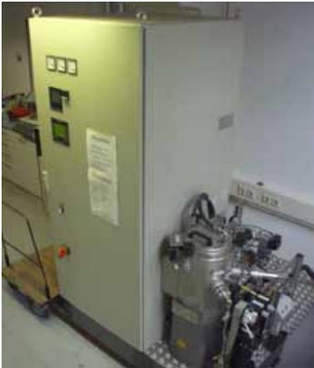
**Abb.44: Vakuumsinteranlage FSW**
