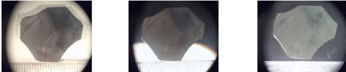
Abb.82: Y-Zr-O, Argonatmosphäre (1700°C / 2 h)
