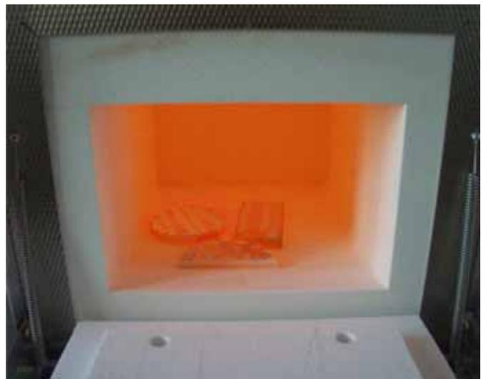
**Abb.157: Reoxidation der Proben bei 900°C**
