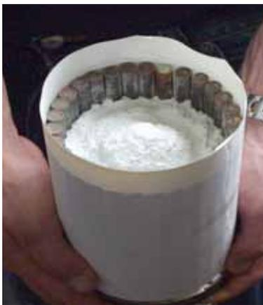
**Abb.33: Tiegel mit ZrO<sub>2</sub>**
