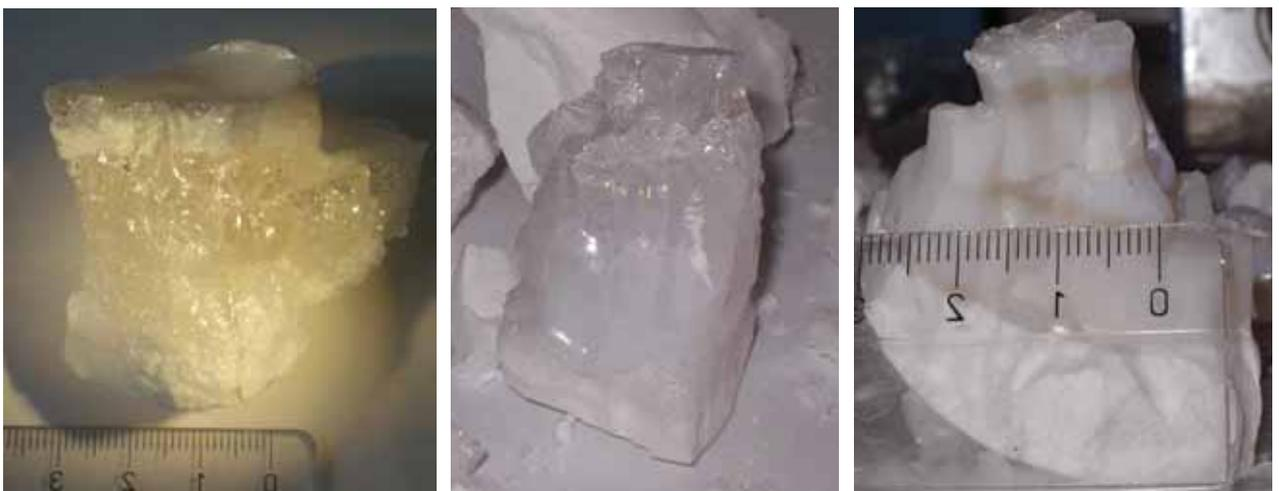
**Abb.121: Einkristalle im System Mg-Zr-O v.l n.r (MgO: 20; 12; 8 mol-%)**
