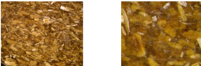
**Abbildung 40 - Lichtmikroskopische Aufnahmen einer PP Probe mit 10 % Rapsstroh;**
