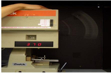
Abbildung 31 - Pendelschlagwerk zur Bestimmung der Schlagzähigkeit
