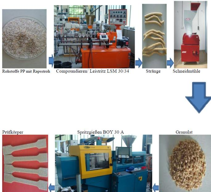
Abbildung 26 - Verfahrensablauf zur Herstellung der Probekörper
