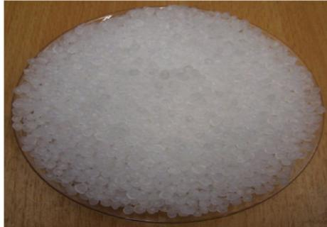
Abbildung 22 - Polypropylengranulat
