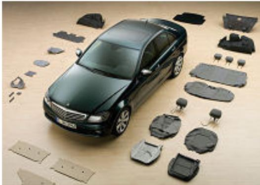
Abbildung 8 - Bauteile mit Füllstoffen aus nachwachsenden Rohstoffen im Auto (32)
