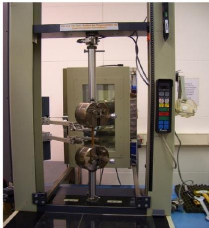
Abbildung 28 - Zugprüfmaschine
