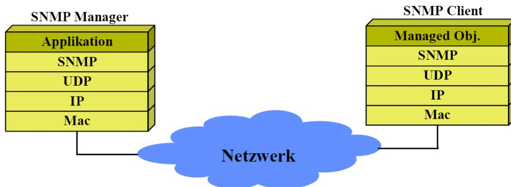
Abbildung 2.8: SNMP Netzwerk [Sta93]
