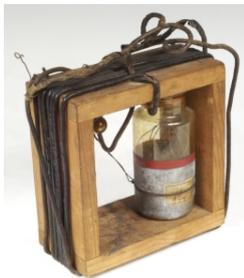
ABBILDUNG 1.1. *G. Marconi*'s erster frequenzabstimmbarer Transmitter (1899)
