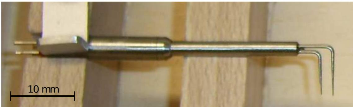
Abbildung 3.19: Hitzdrahtsonde zur Bestimmung zweier Richtungskomponenten
