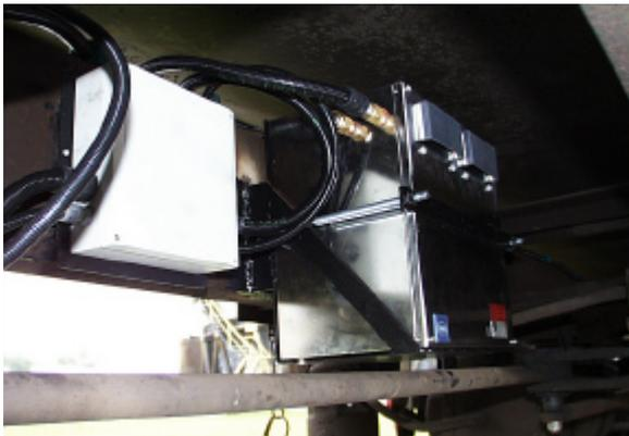
**Bild 74: ATIS (links) und Batteriekasten (rechts) des Druckgaswagens**
