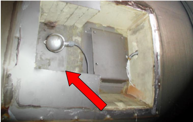
**Bild 90:** Einbauort des Kesseltemperatursensors am Chemiekesselwagen (Blick auf die Kesselseite)
