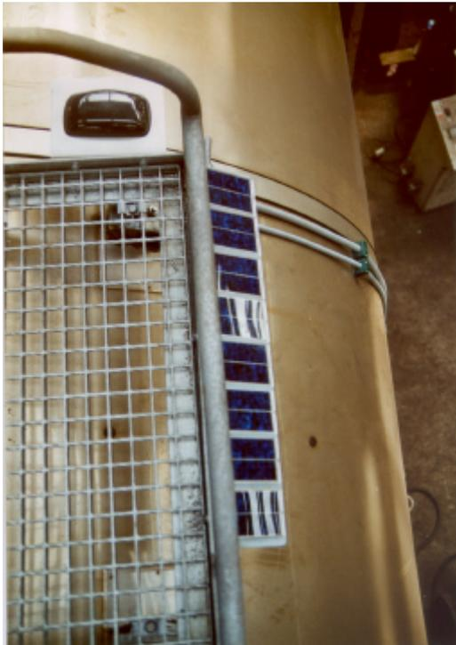
**Bild 102: Solarpaneel des Chemiekesselwagens**
