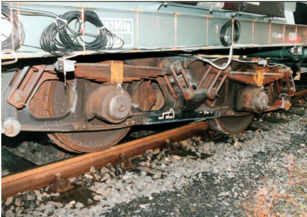
**Bild 66: Zustand nach der Entgleisung bei 43 km/h und leerem Kesselwagen**
