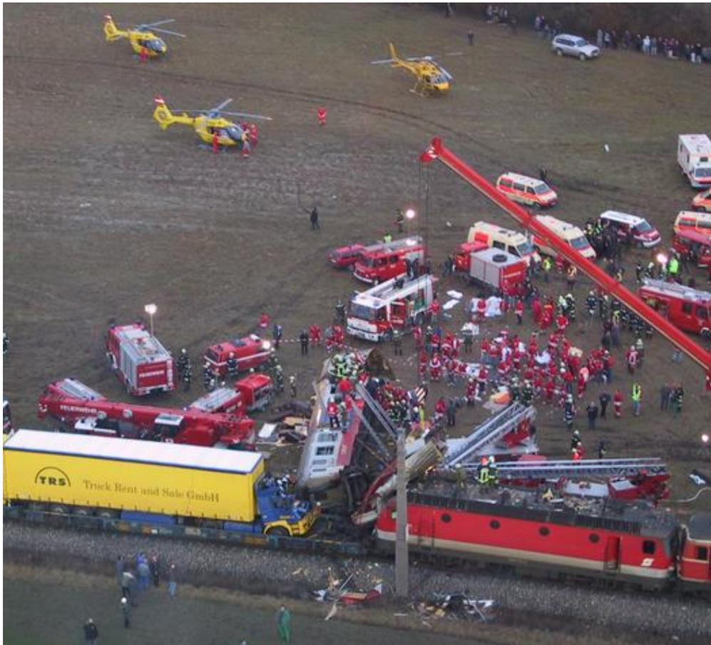
**Bild 62: Zugunglück in Wampersdorf infolge Bremsdefekt (mangelhafte Bremsprobe) am 26.02.2002 [150]**
