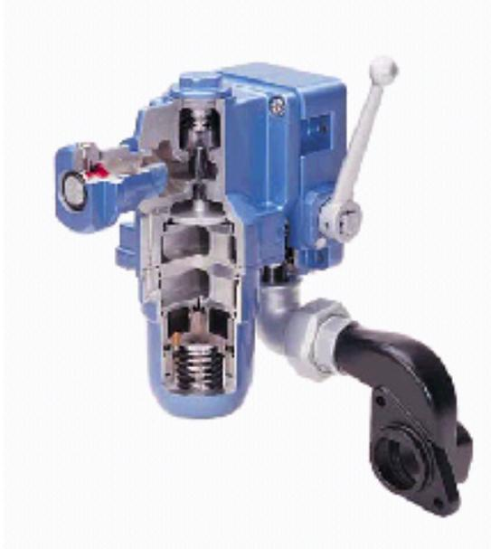
**Bild 105: Mechanischer Entgleisungsdetektor der Fa. Knorr-Bremse**
