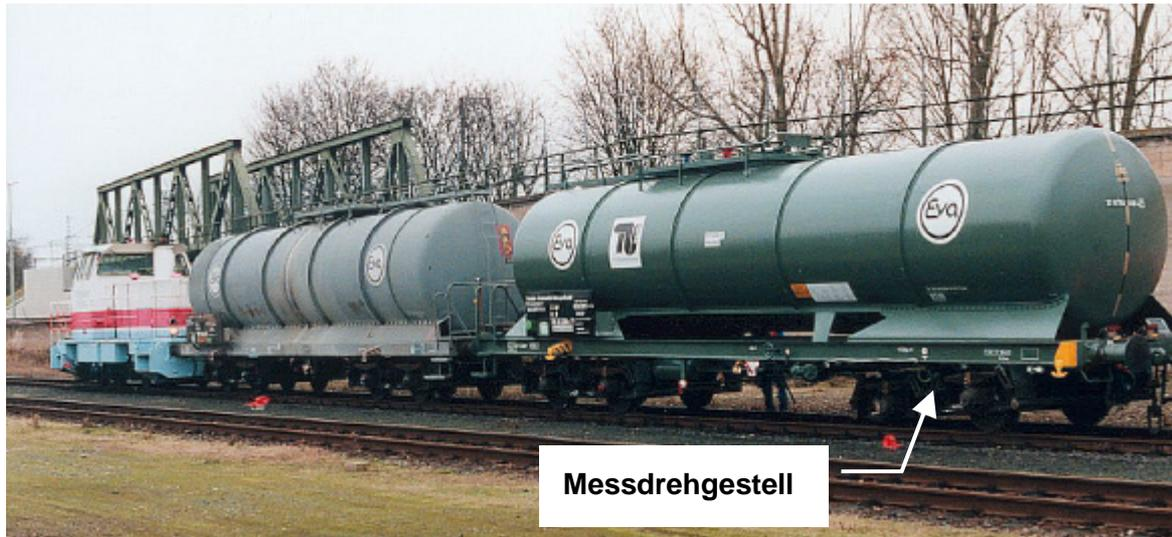
**Bild 15: Messzug der Entgleisungsversuche 1999 auf dem Werksgelände der Fa. Infaserv Hoechst [117]**
