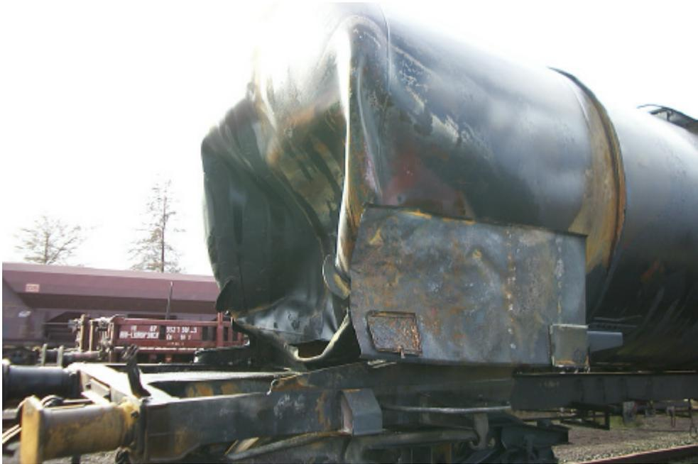
**Bild 60: Kesselwagen nach einer Entgleisung bei langsamer Fahrt (2002)**
