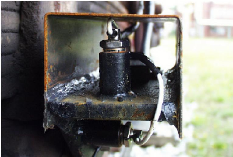
**Bild 78:** Piezoelektrischer Beschleunigungssensor zur Achslagerdiagnose des Druckgaswagens
