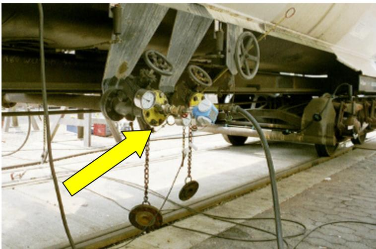
**Bild 92:** Einbauort des Referenzsensors zur Überprüfung des Kesselinnendruckes
