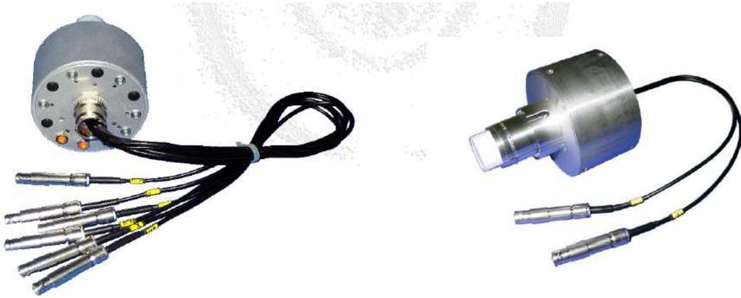
**Abbildung 4.15:** Die Decoupling Box wird an die FT12-TP Vakuumdurchführung angeschlossen. Sie ermöglicht die Spannungsversorgung durch sechs SHV-Hochspannungsstecker und das Auskoppeln der MCP- und Anoden-Signale durch LEMO-Buchsen. Ionen- und Elektronen-Detektor haben jeweils eine eigene Decoupling Box. Links ist die Box mit den Steckern und den LEMO-Buchsen zu sehen. Rechts ist die Steckverbindung für die Vakuumdurchführung zu erkennen.
