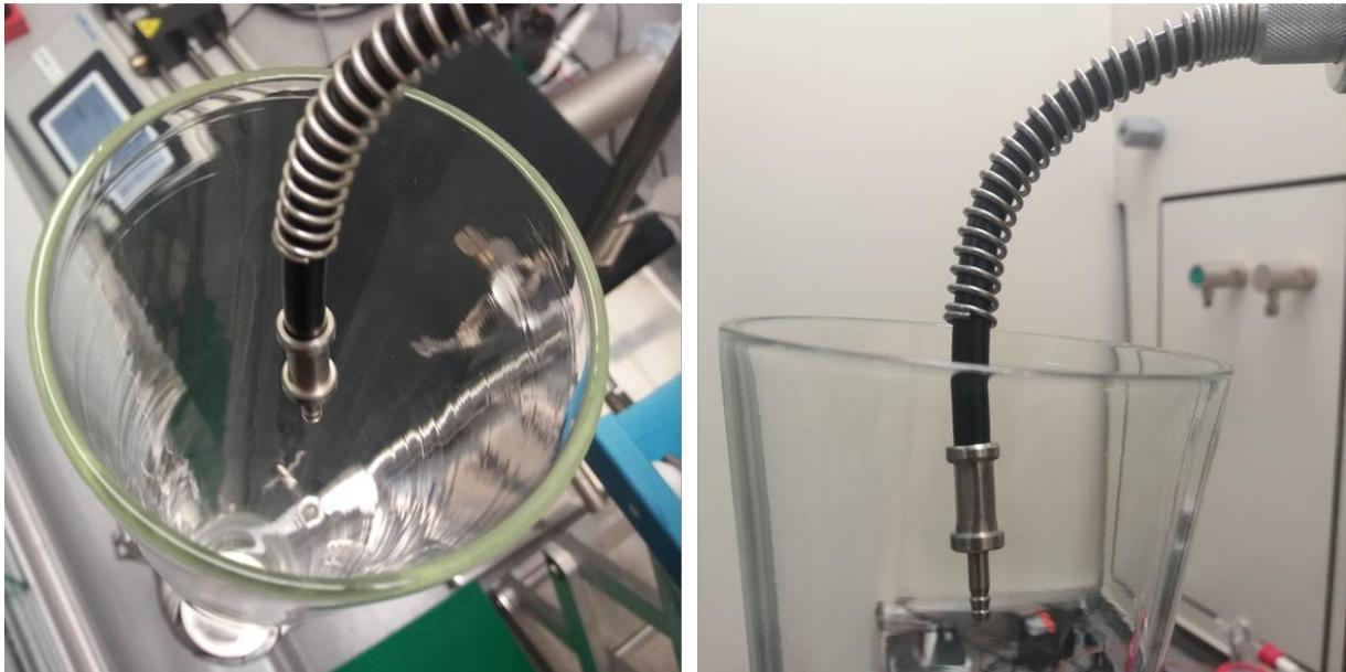
Abbildung 4.4 Messung der Substanzkonzentrationen mit dem PID.
