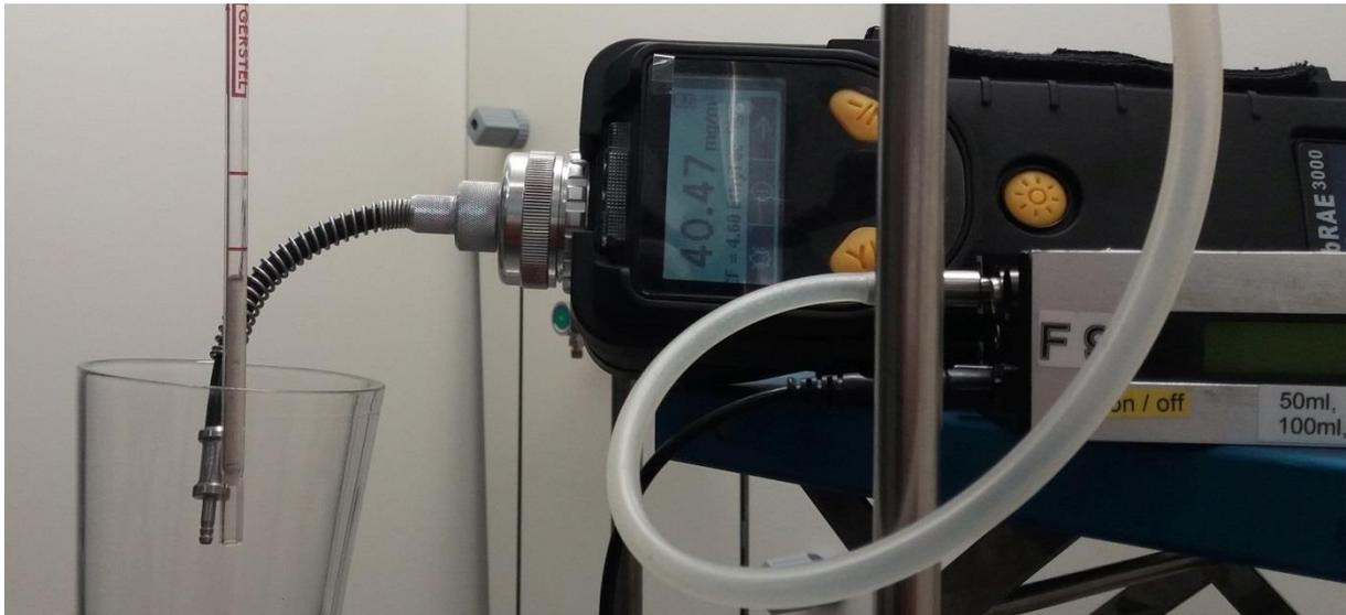
Abbildung 4.6 Probenahme mit Tenax<sup>®</sup>-Röhrchen und FLEC-Pumpe sowie Parallelmessung mit PID.
