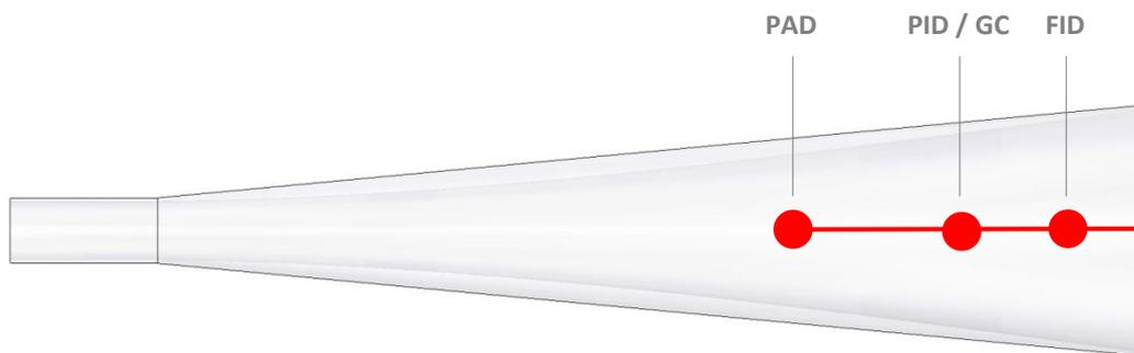
Abbildung 4.2 Probenahmestellen für PAD, PID, GC und FID mittig des Trichterquerschnittes.
