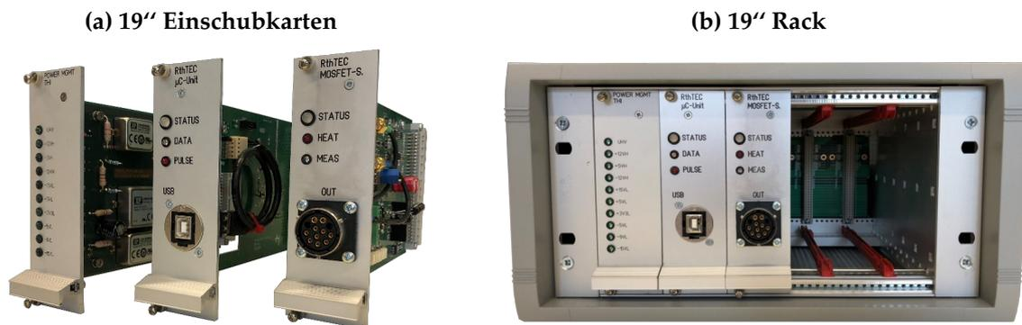
Abbildung 6.1: Modulares TTA-Equipment auf Basis eines 19"-Einschubsystems. (a) Drei Einschubkarten (Power-Supply-Unit, Control-Unit und Heiz-/Mess-Quelle für MOSFETS) und (b) 19"-Rack mit fünf Slots (Drei belegte Slots links und 2 frei Slots rechts).
