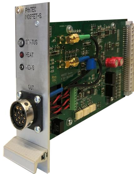
Abbildung 5.4: Prototyp der Heiz/Mess-Quelle, realisiert als 19 Zoll Einschubkarte
