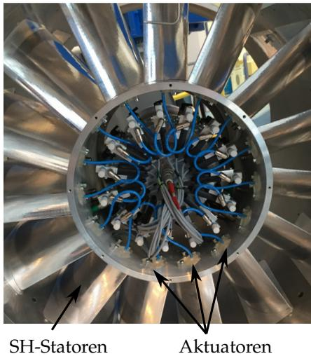
**Abbildung 5.2:** Ringraum mit SH-Statoren und eingebauten Drucktank mit angeschlossenen Aktuatoren in der Nabe
