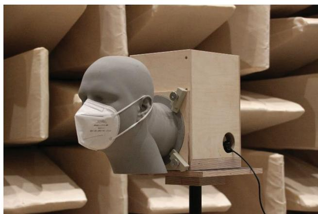
**Abbildung 3:** Konstruktion eines 3D gedruckten Kunstkopfes mit Flanschverbindung an einem Holzgehäuse für die TalkBox im Reflexionsarmen Raum (RaR) der TU Berlin
