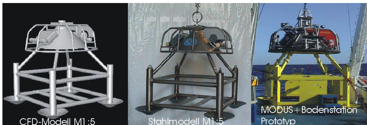
Abb. 1-12: (v.l.n.r.) CAD- und Stahlmodell von MODUS (jeweils Maßstab 1:5) und Prototyp von MODUS sowie eine Testversion der Bodenstation
