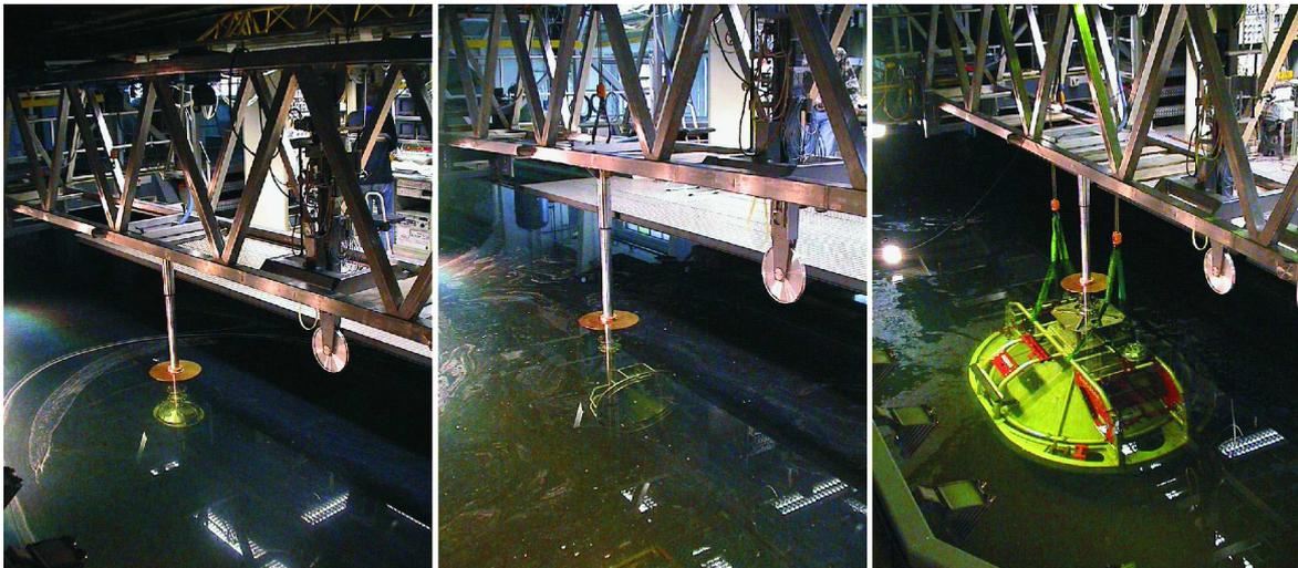
Abb. 5-13: Widerstandsversuche in der Tiefwasserrinne der ZE VWS der TU Berlin (v.l.n.r.): Modelle von MODUS in M1:5, M1:3 (hier für Vertikalfahrt hochkant montiert) und der Prototyp
