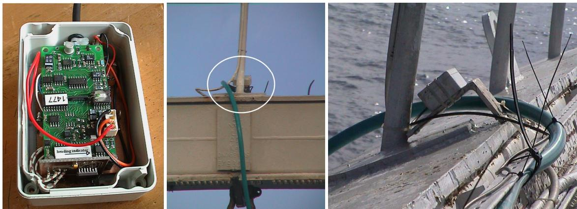
Abb. 4-6: (v. l. n. r.) Kompass und Beschleunigungssensor als Einheit - montiert am A-Rahmen in Parkposition
