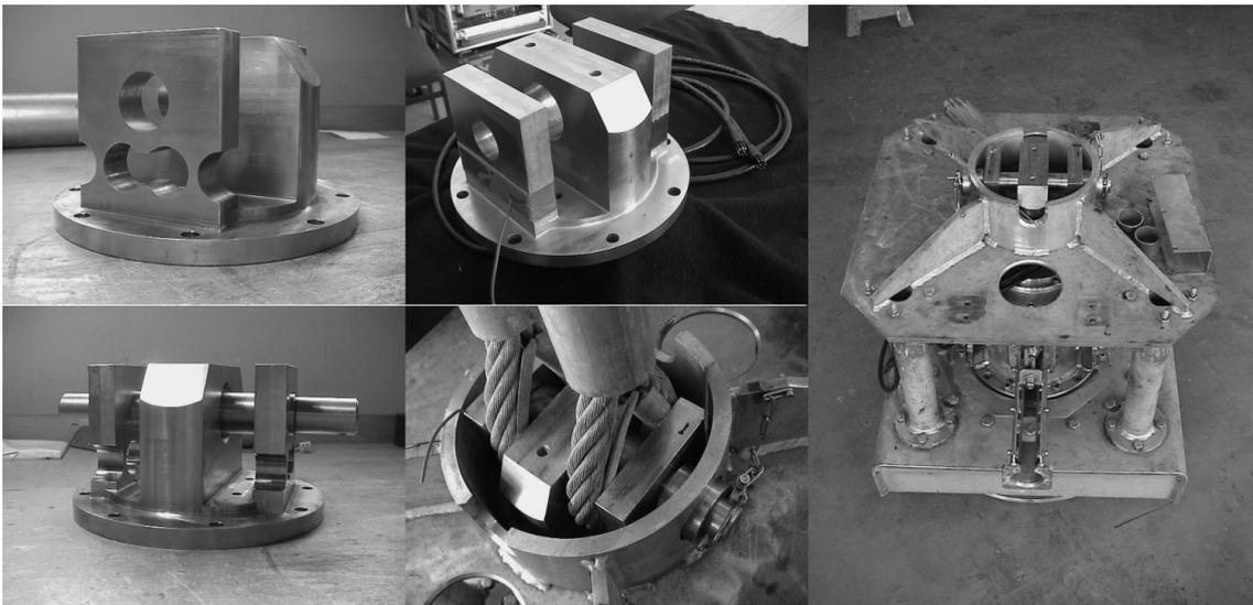
Abb. 4-4: Die Kraftmesswaage nach der Metallbearbeitung (links oben und unten), nach DMS-Applikation, Verkabelung und Verguss der Klebezonen (Mitte oben) und im eingebauten Zustand (Mitte unten und rechts)
