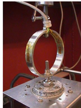
Abb. 5-2: Die Kraftmesswaagen am oberen (links) und unteren Ende des Testkabels
