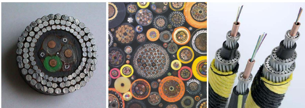
Abb. 1-4: (v.l.n.r.) Schnitt durch das *umbilical* von MODUS (Durchmesser 0,254 m (1 Zoll), Masse 2,276 kg/m) sowie eine Auswahl weiterer *umbilical* und beispielhafter Kabelstrukturen (nicht maßstabgetreu)
