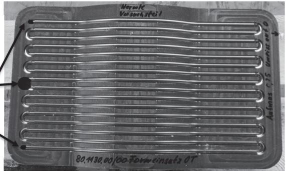
Abbildung 5-6: Gefräster variothermer Werkzeugeinsatz
