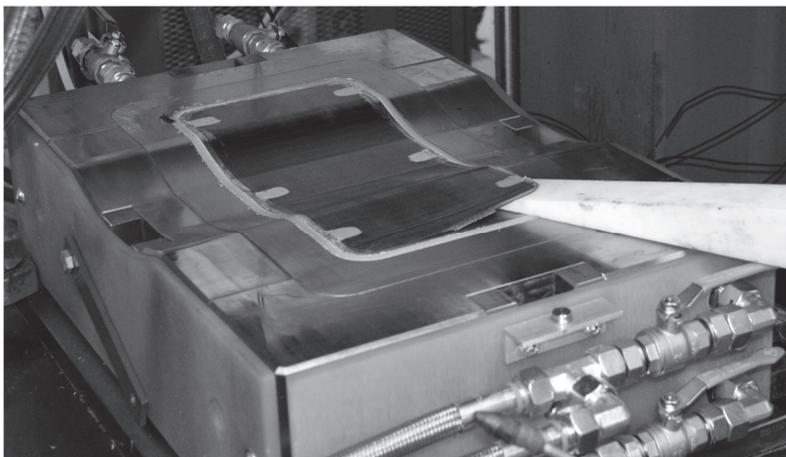
Abbildung 5-12: Entnahme des ausgehärteten CFK-Bauteils
