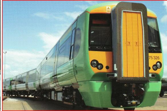
Abb. 9-2: englischer Triebzug Electrostar, Baureihe 375/377 (Bildquelle: Prospekt Fa. Bombardier)
