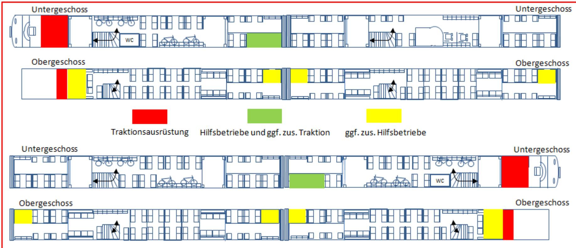
Abb. 8-31: Fahrzeuglayout eines vollständigen Doppelstock-Triebzuges mit kleinen Rädern, außermittiger Übergangsanordnung und Ausstattung analog KISS für die ODEG, jedoch mit weniger Klappsitzen
