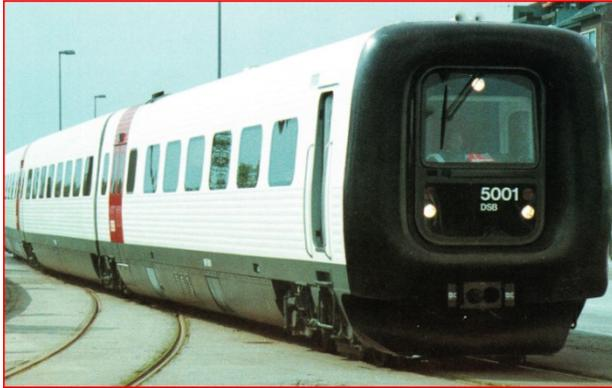
Abb. 9-1: Dieseltriebzug IC3 der DSB (Bildquelle: Prospekt Fa. Alusuisse)
