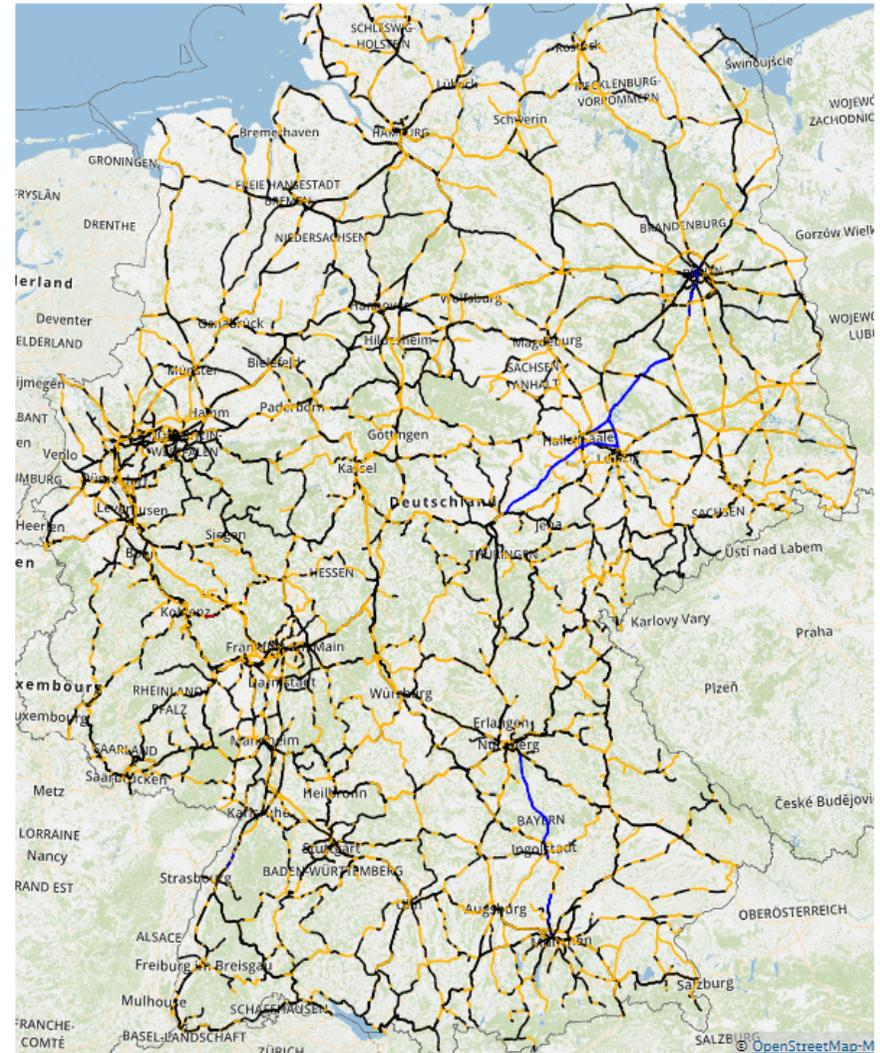
Abb. 4-4: Strecken in Deutschland mit erweiterter kinematischer Begrenzungslinie GC nach [65] (blau dargestellt)
