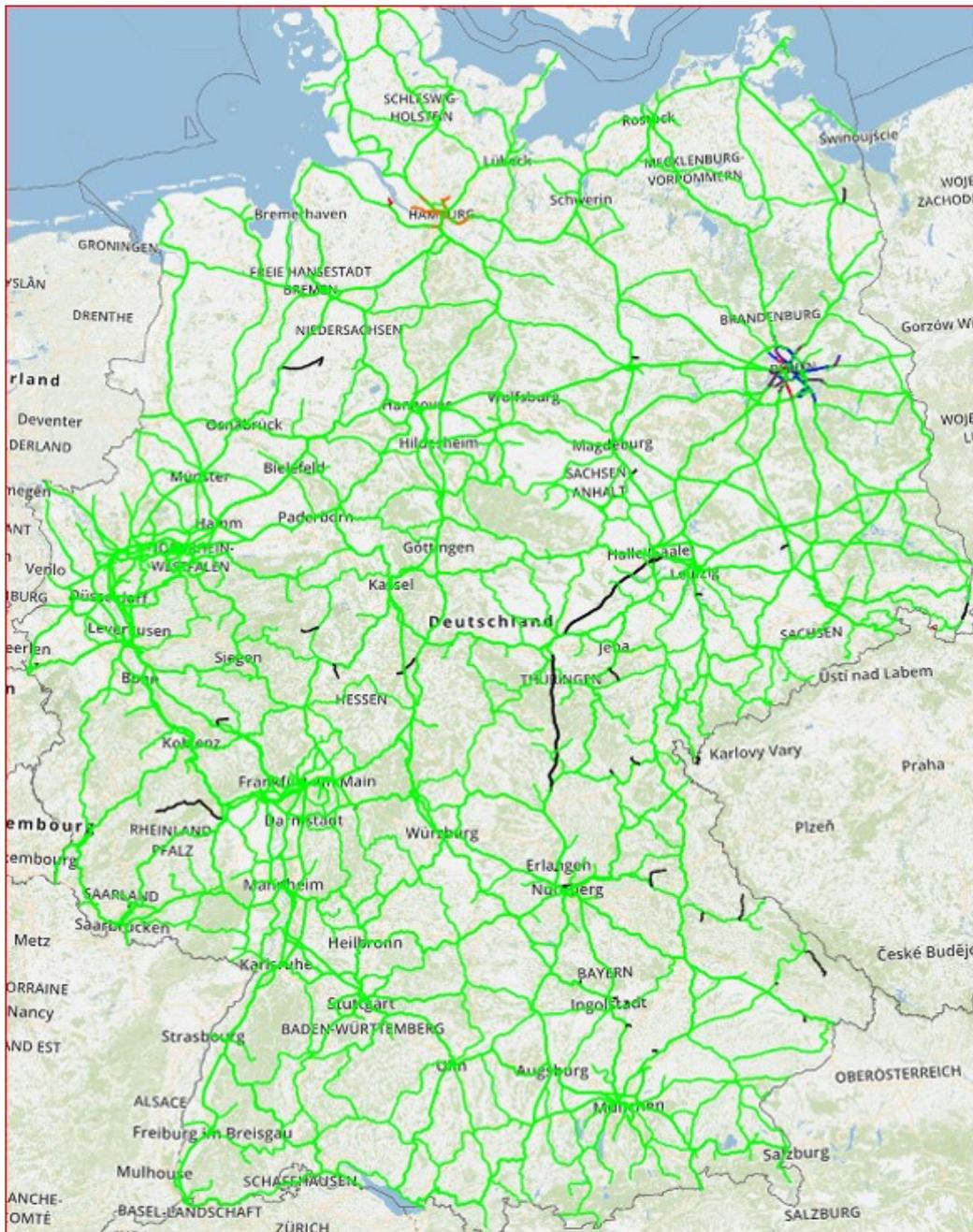
Abb. 4-8: Zugsicherungssysteme in Deutschland, hier PZB (grün) nach [65]
