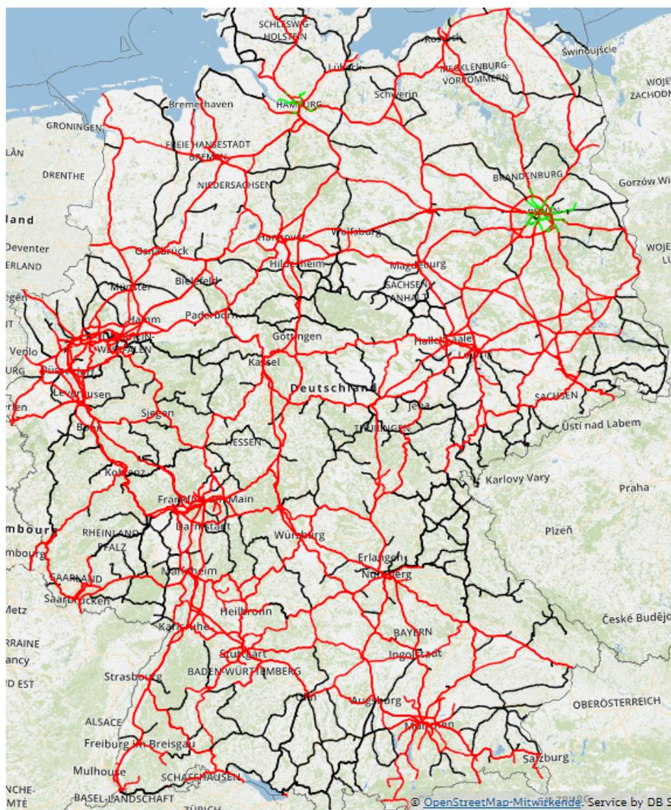
Abb. 4-7: Strecken in Deutschland mit elektrischer Energieversorgung (rot: 15 kV, grün: Gleichspannung, schwarz: ohne Energieversorgung nach [65])
