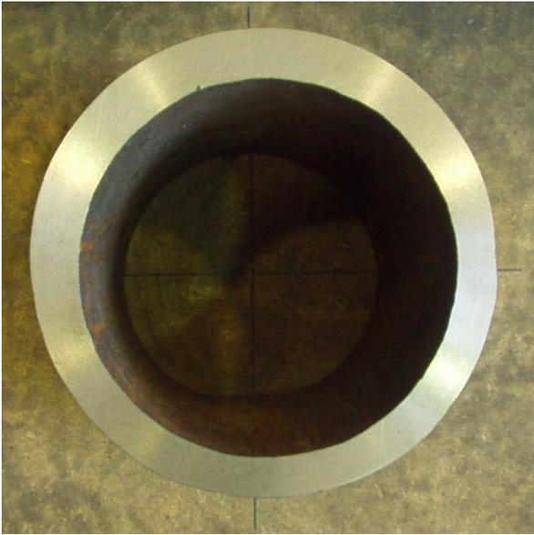
**Abb. 2.6:** Querschnitt mit Versatz
