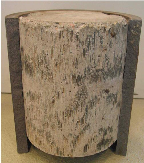
**Abb. 3.16:** Probe A5, Reibspuren auf dem Betonkern
