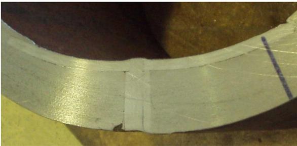
**Abb. 2.8:** Fehlstelle: Kernstütze mit Halterung
