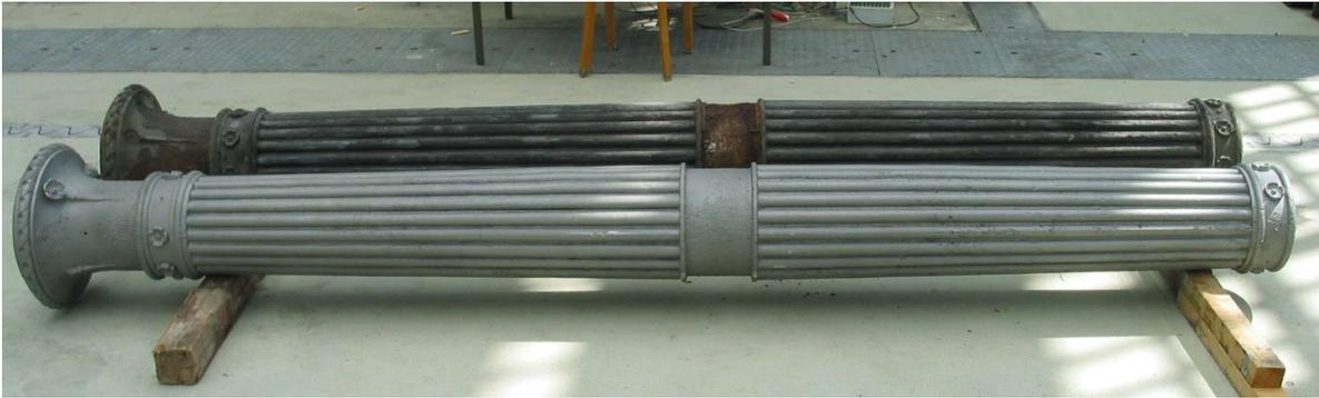
**Abb. 3.21:** Ansicht Gussstützen
