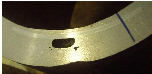
**Abb. 2.9:** Fehlstellen: Kernstütze und Gasblase
