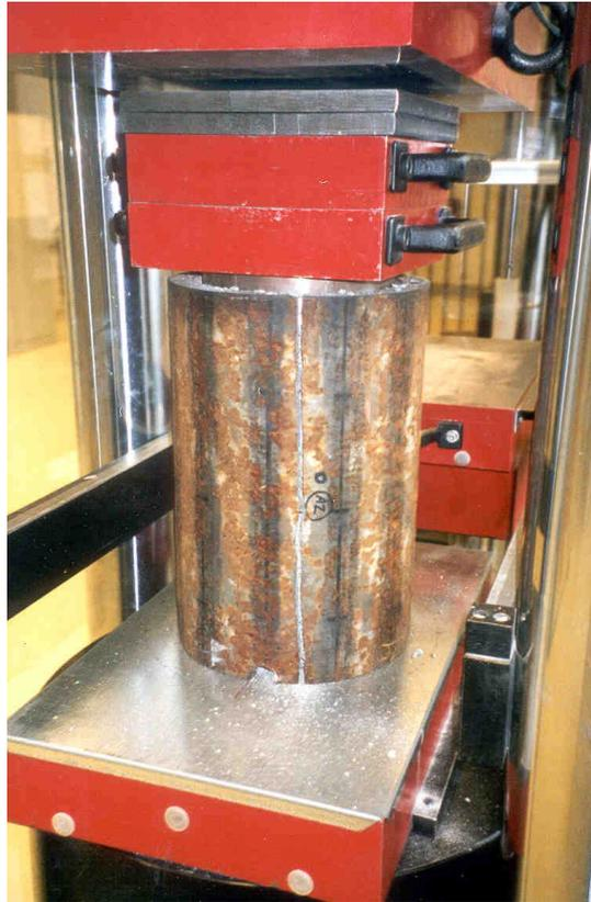
**Abb. 3.15:** Versuchsaufbau für die Push-Out-Versuche mit Probe A2 nach der Belastung
