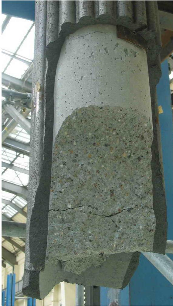
**Abb. 3.31:** Bruchbild Stütze 3
