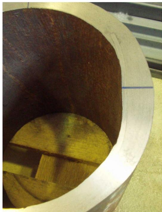
**Abb. 3.13:** Probe A6 mit Querschnittsdeformation und eingeschlossener Kernstütze
