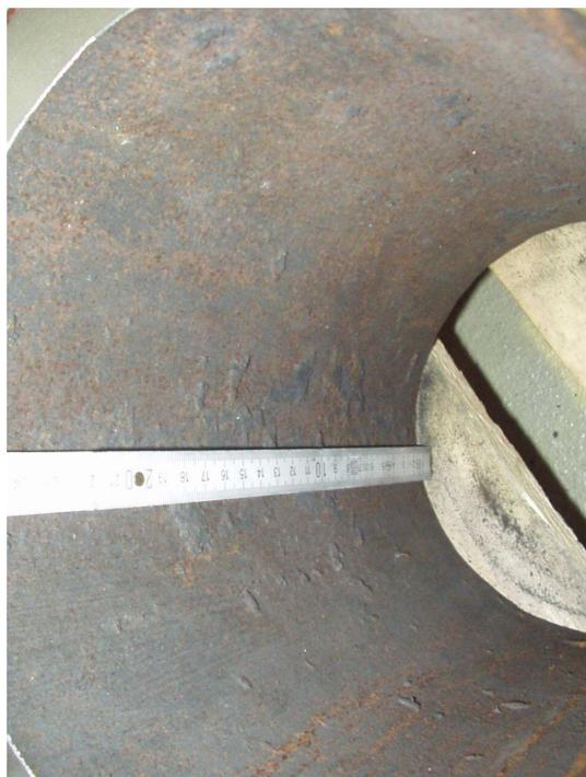
**Abb. 3.12:** Probe A5 mit Schlacke
