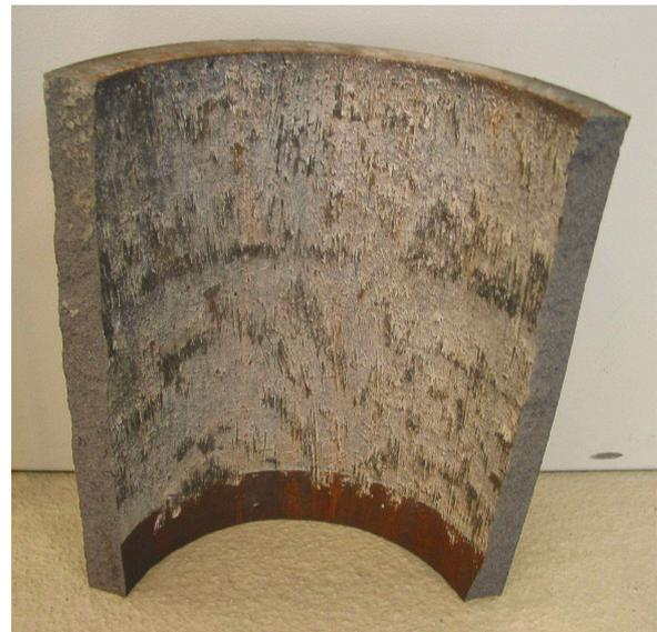
**Abb. 3.17:** Probe A5, Reibspuren auf dem Gussmantel
